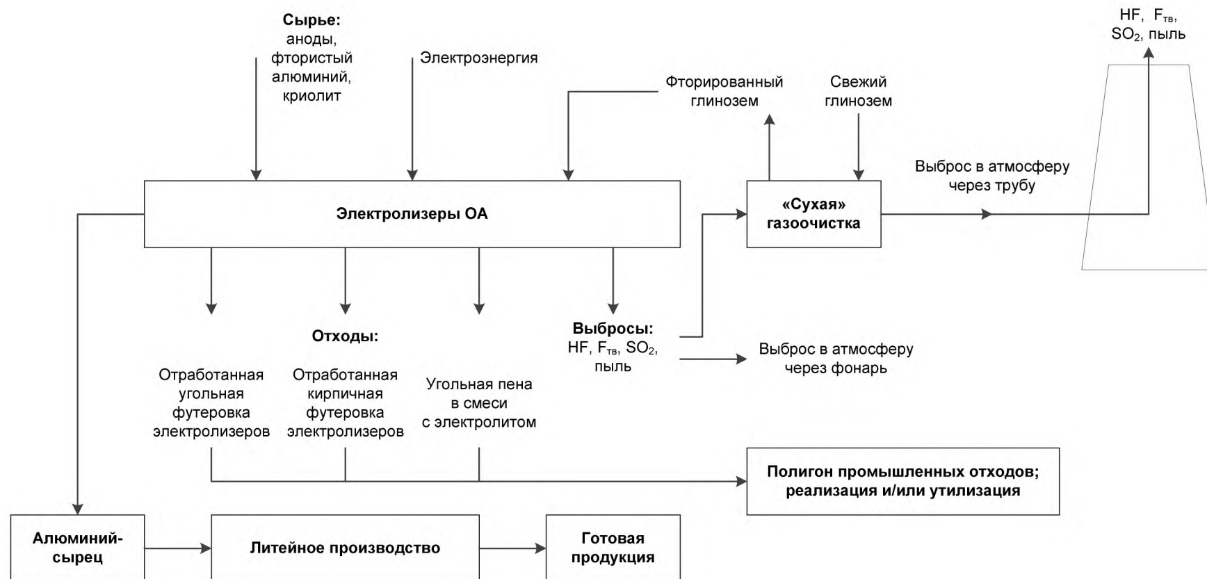
Рисунок 2.5 — Блок-схема производства первичного алюминия в электролизерах с ОА
