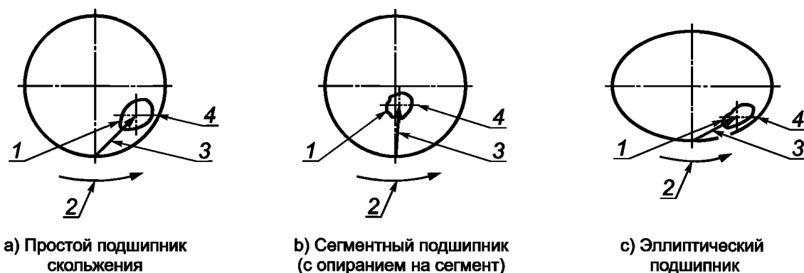
Рисунок С.5 — Типичные картины движения вала в гидродинамических подшипниках
