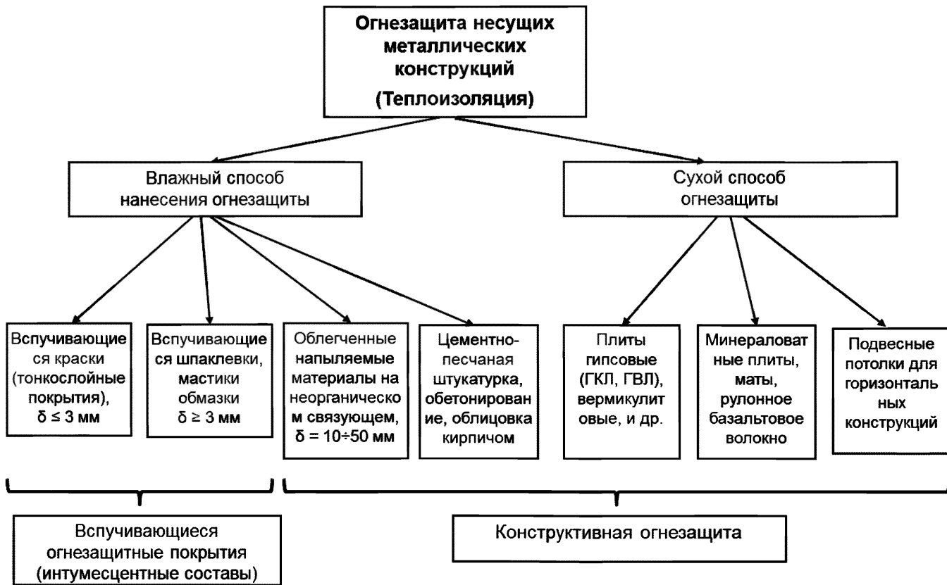
Рисунок 2 – Общая схема по средствам и способам огнезащиты несущих металлических конструкций.
