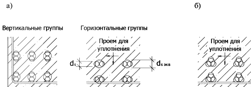
Рисунок 3.2 – Расположение групп из двух (а) и трех (б) соприкасающихся стержней
