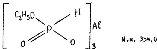
Фозетил АІ - этилфосфит алюминия. Температура плавления 200°С с разложением. Растворимость в воде 120 г/л при 20°С, в метиленгликоле - 80 мг/л.
