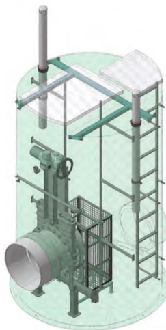
Рис.26. Колодец с сороудерживающей корзиной и шиберным затвором
