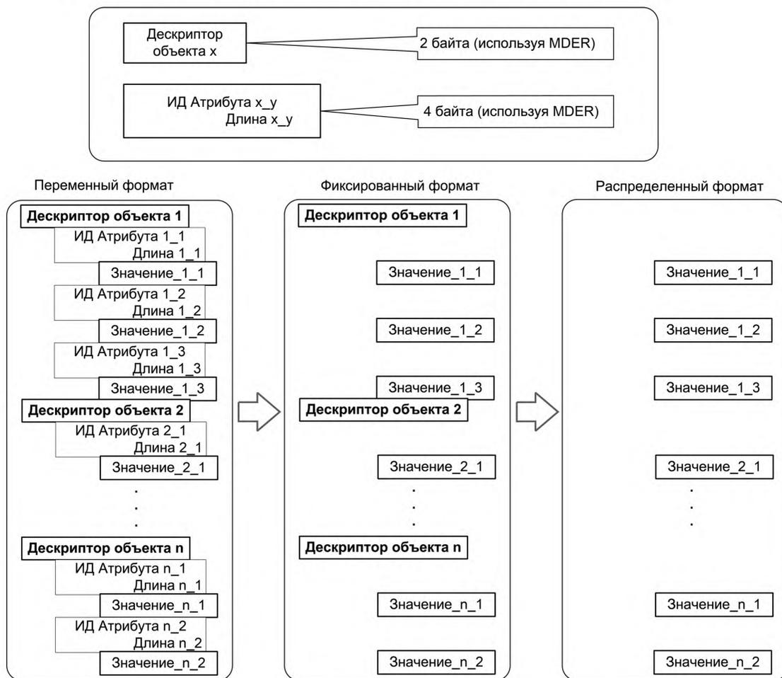
Рисунок 10 — Сравнение разных форматов отчетов об измеренных данных
