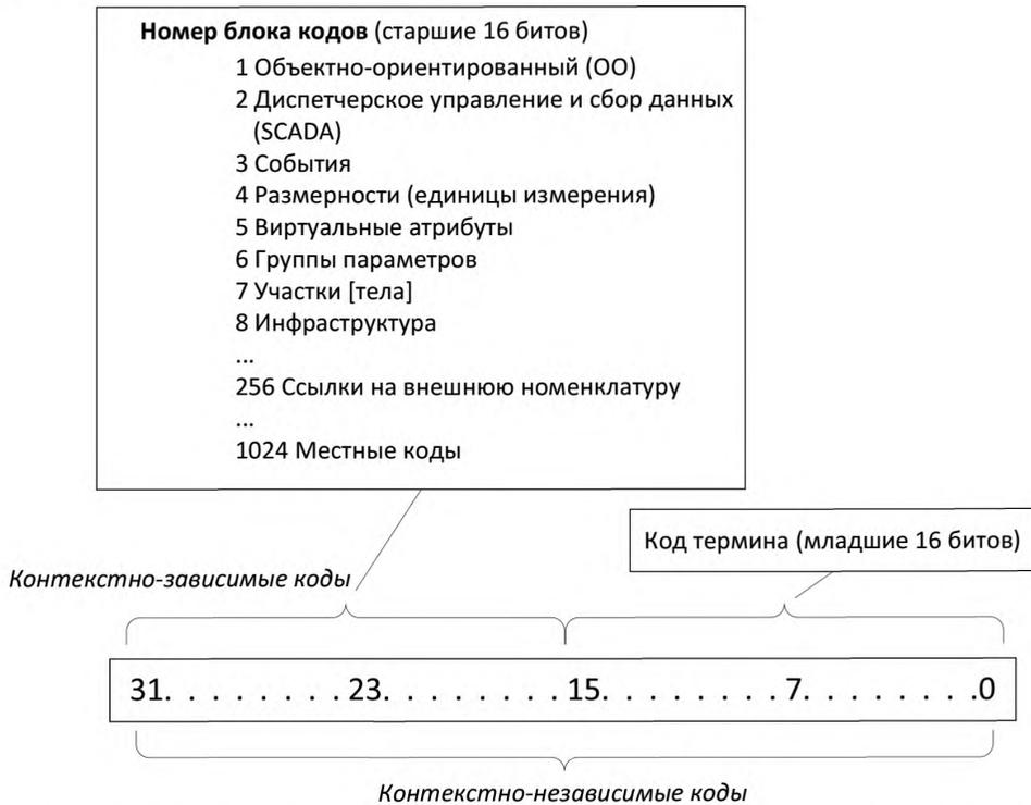
Рисунок 9 — ИСО/ИИЭР 11073-10101:2004(Е) [B41]: сборка контекстно-независимых кодов из кода блока и конкретных терминов в блоке
