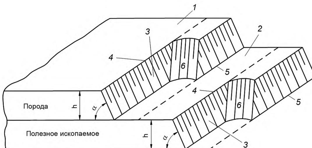
1 — верхняя площадка уступа; 2 — нижняя площадка уступа; 3 — откос уступа; 4 — верхняя бровка уступа; 5 — нижняя бровка уступа; 6 — забой;  $\alpha$  — угол откоса уступа;  $h$  — высота уступа
