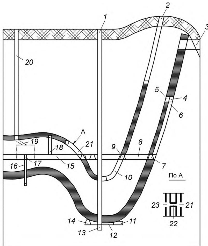
1, 2, 16 — стволы (вертикальный, наклонный и слепой); 3 — штольня; 4, 7, 9, 14 — штреки (вентиляционный, откаточный, промежуточный и полевой); 5 — орт; 6 — скат; 8, 12, 15 — квершлагы (восточный, околоствольный и западный); 10 — уклон; 11 — камера; 13 — зумпф; 17, 23 — ходки (камерный и бремсберговый); 18 — гезенк; 19 — сбойка; 20 — шурф; 21 — бремсберг; 22 — просек
