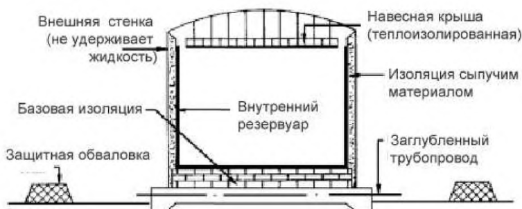
Рисунок 9 – Резервуар с одинарной стенкой
