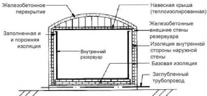
Рисунок 11 – Резервуар с полной защитной оболочкой
