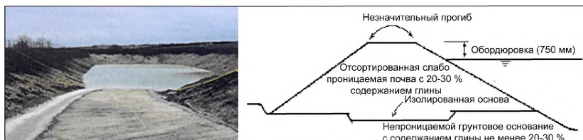
Рисунок 14 – Пример организации пруда-отстойника
