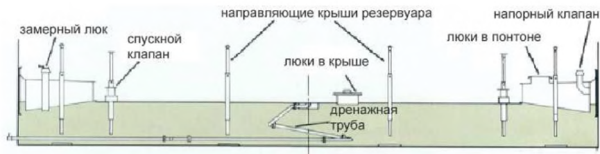
Рисунок 2 – Пример типичной плавающей понтонной крыши
