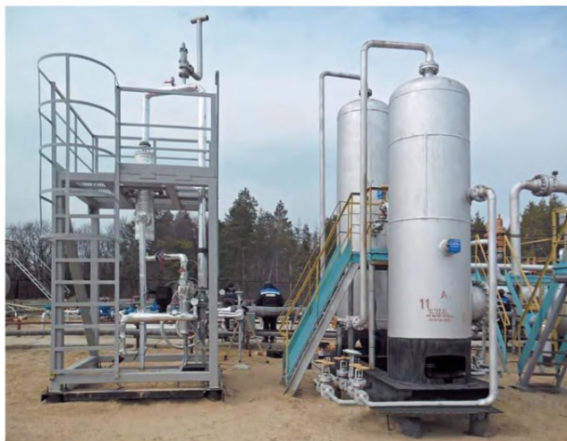
Рисунок 7.12 – Мембранная гелиевая установка
