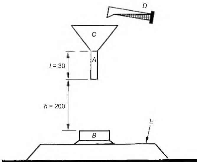
*A – трубка воронки с внутренним диаметром 8 мм;
