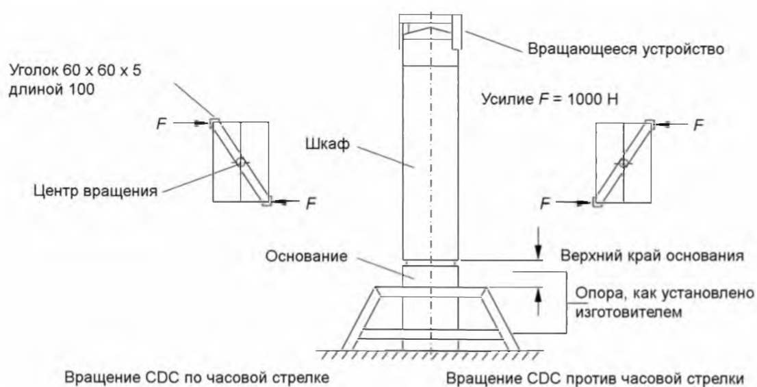
Рисунок 105а – Схема испытания устойчивости CDC к крутящей нагрузке
