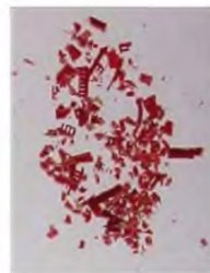
Рисунок 10с – Корпус ИМС после разделения
