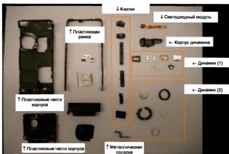
Рисунок 6 – Полная разборка нижней части корпуса
