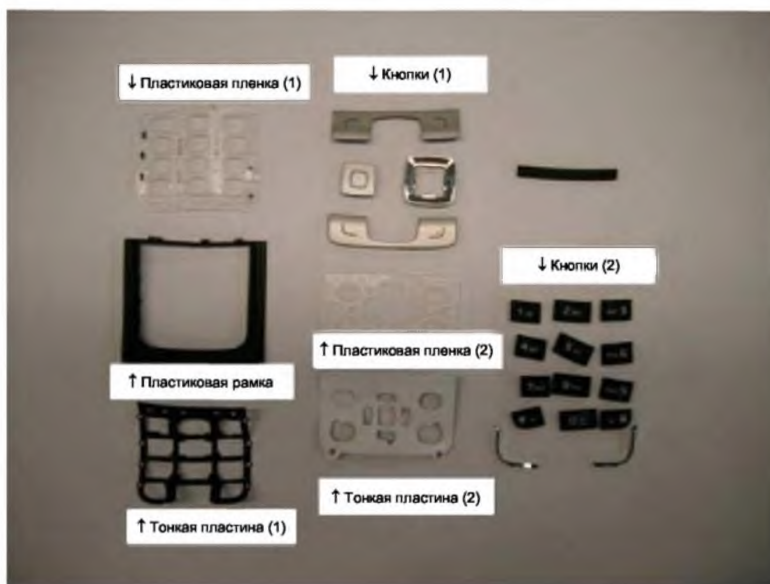
Рисунок 5 – Полная разборка клавиатуры
