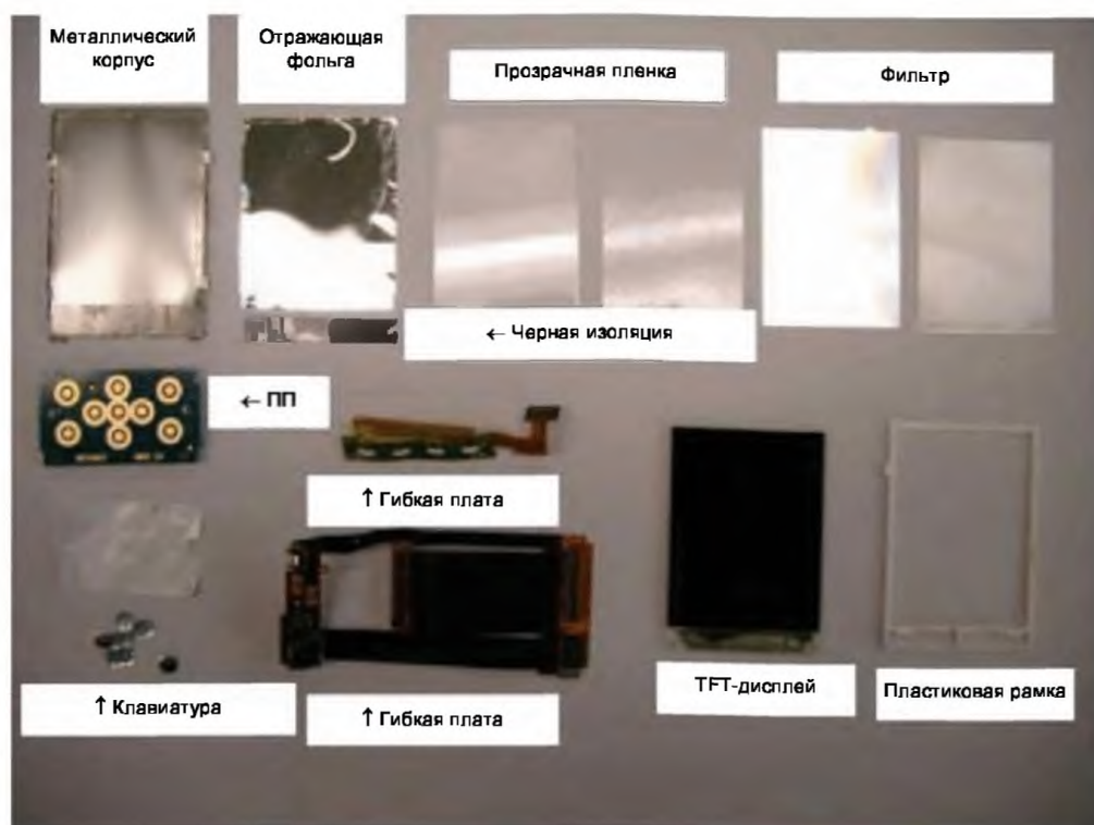
Рисунок 8 – Компоненты TFT-дисплея сотового телефона после частичного разделения
