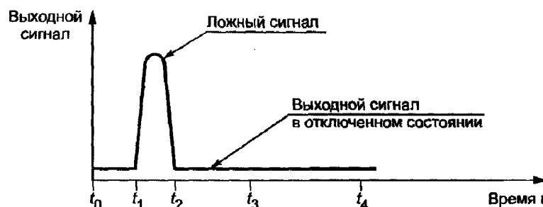
Рисунок 7б – Коммутационный элемент в отключенном состоянии
