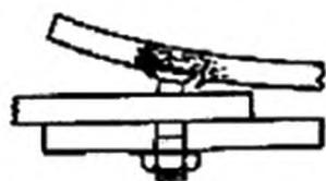
PLT (протягивание ламинаата, отверстие в ламинате, вверху)
