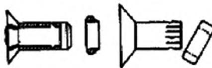
FFS (напряжение болта, фланец, сдвиг фланца)
