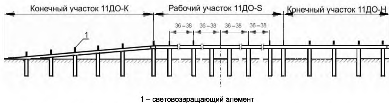
Рисунок Д.9 – Установка световозвращающих щитков ЩС5 на дорожном ограждении
