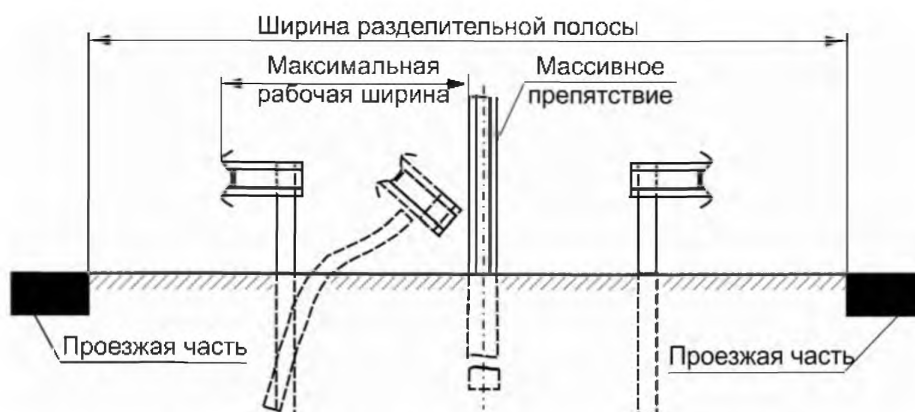
Рисунок Г.4 – Рабочая ширина дорожного ограждения, установленного на разделительной полосе
