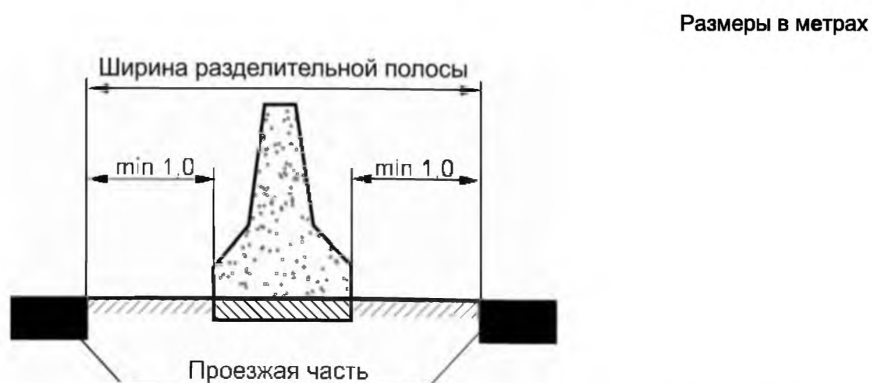
Рисунок Г.11 – Расположение недеформируемого дорожного ограждения на разделительной полосе
