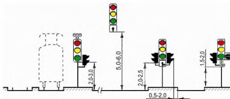
Рисунок К.1 – Расположение светофоров относительно проезжей части
