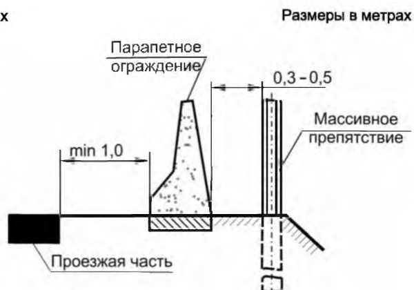
Рисунок Г.10 – Расположение недеформируемого дорожного ограждения возле массивного препятствия
