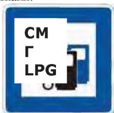
6.3a - автозаправочная станция на сжиженном нефтяном газе (СНГ)
