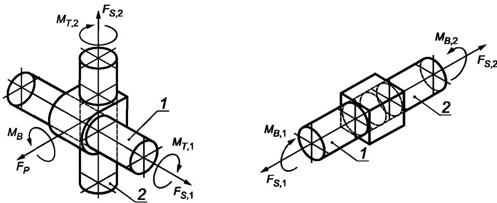
а) Угловая муфта для соединения под прямым углом      б) Стыковочная муфта фрикционного типа
