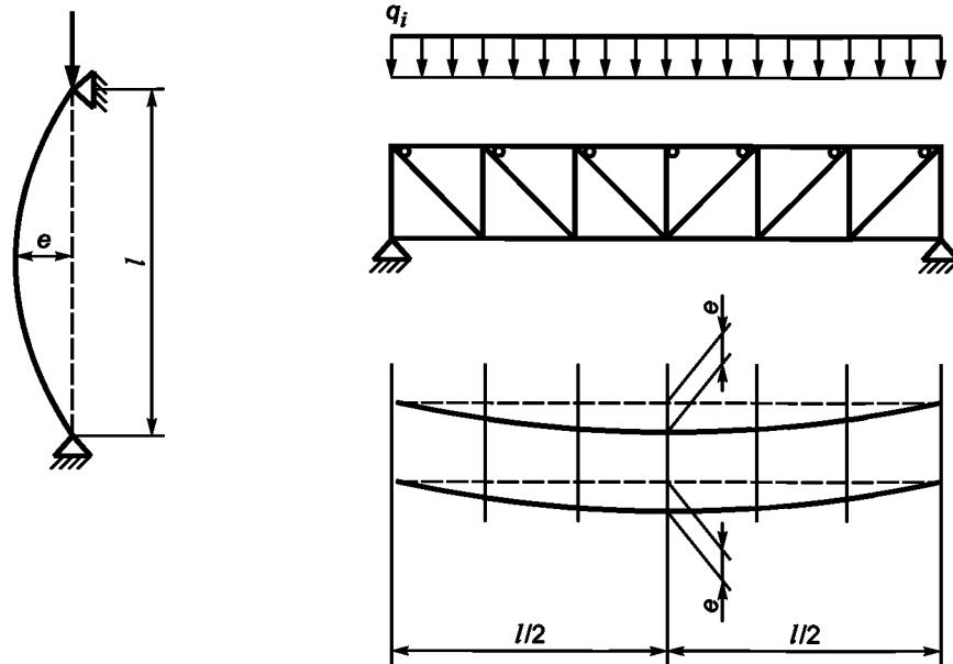
а) Вид сбоку раскрепленной стойки
