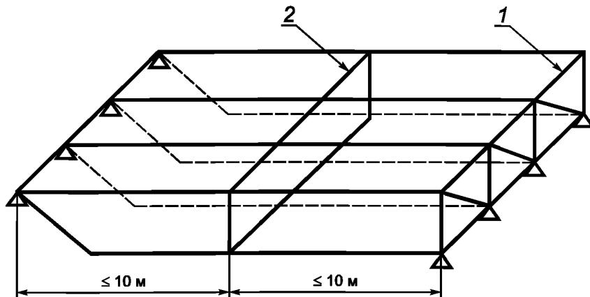
1 — крайние поперечные связи; 2 — промежуточные поперечные связи
