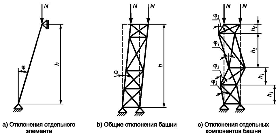
$h_i$  — расстояние по вертикали между соседними горизонтальными элементами, расположенными друг над другом;
