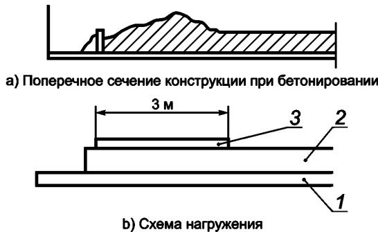
1 — участки доступа: минимальная рабочая нагрузка класса 1 в соответствии с EN 12811-1; 2 — нагрузка от веса поддерживающего бетона; 3 — поправка на скопление бетона при бетонировании
