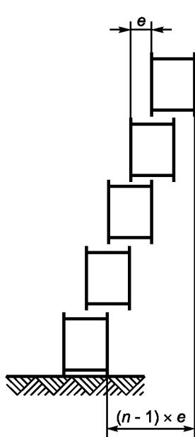
с) Смещения, приводящие к поперечным отклонениям
