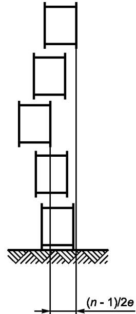
д) Смещения, приводящие к изгибным отклонениям
