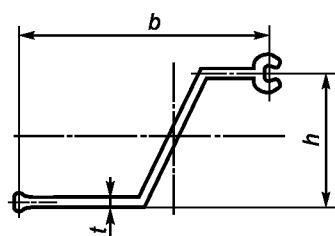
$b$  — ширина композитного шпунта;  $h$  — глубина композитного шпунта;  $t$  — толщина композитного шпунта
