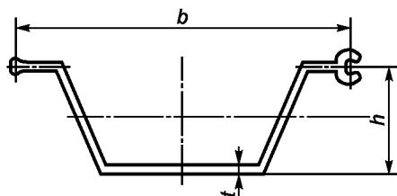
$b$  — ширина композитного шпунта;  $h$  — глубина композитного шпунта;  $t$  — толщина композитного шпунта
