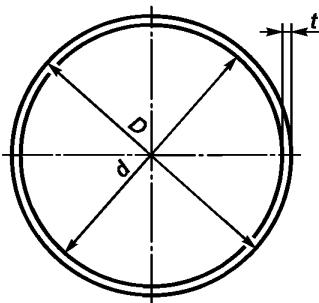
$D$  — наружный диаметр композитного шпунта;  $d$  — внутренний диаметр композитного шпунта;
