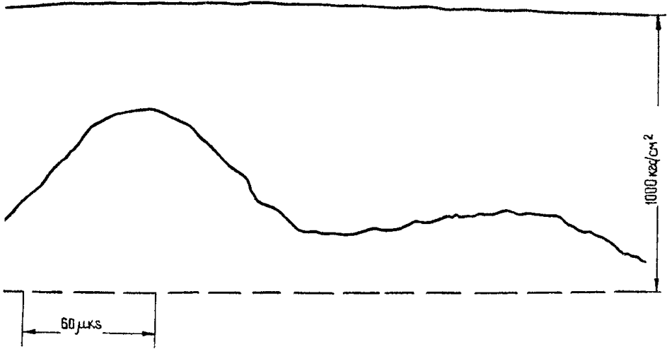
Рис. 8. Осциллограмма ударного силового импульса на штоке рассочего инструмента
