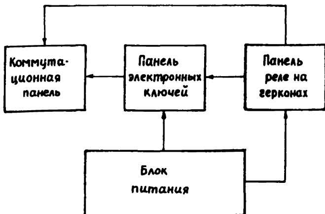
Рис. 2.5. Блок-схема прибора для изменения параметров решаемой задачи.
