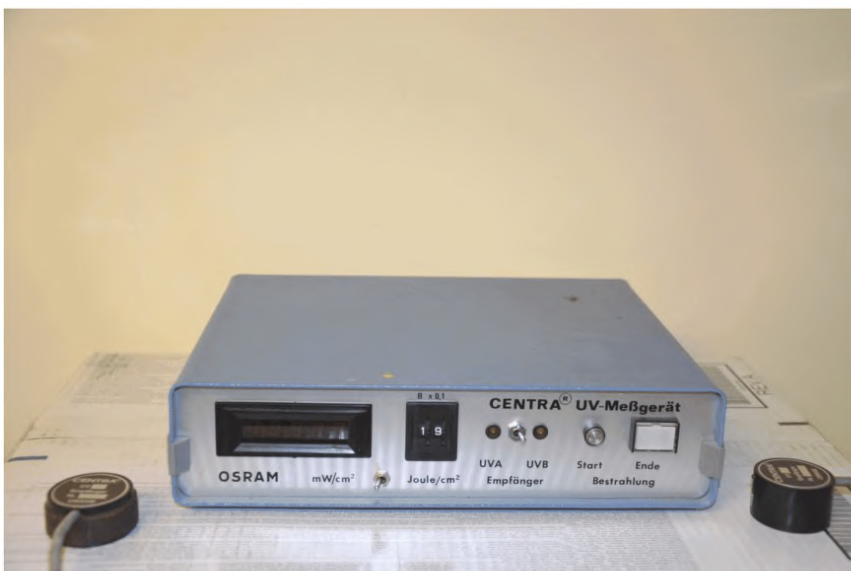
Рисунок Г.9 – Фотоинтенсиметр-дозиметр для измерения интенсивности УФ-излучения
