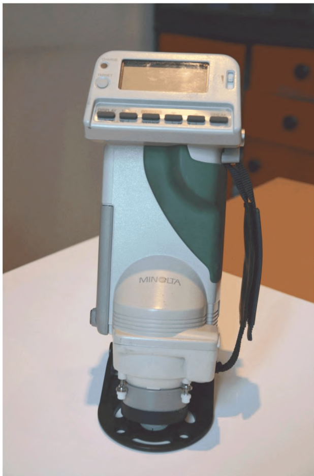
Рисунок Г.7 – Общий вид цветоизмерительного спектрофотометра
