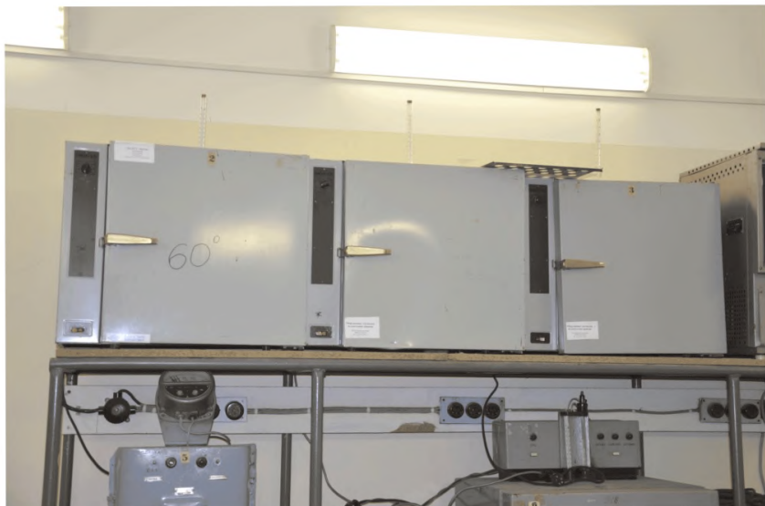
Рисунок Г.6 – Шкафы электрические сушильные «СНОЛ»
