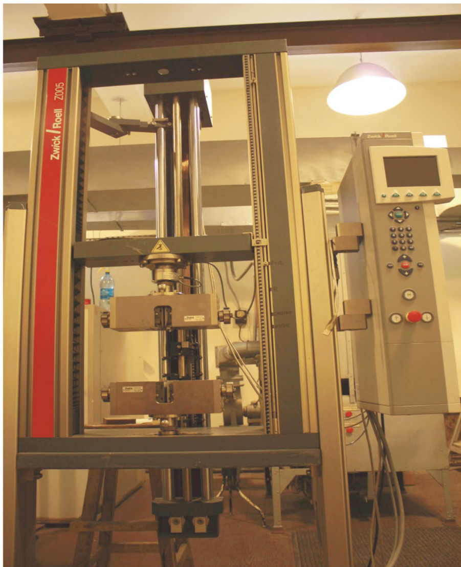
Рисунок Г.5 – Универсальная испытательная машина серии Zwick/Roell Z005
