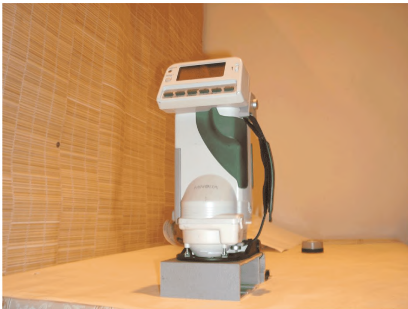
Рисунок Г.1 – Прибор для определения цветовых характеристик по координатному методу
