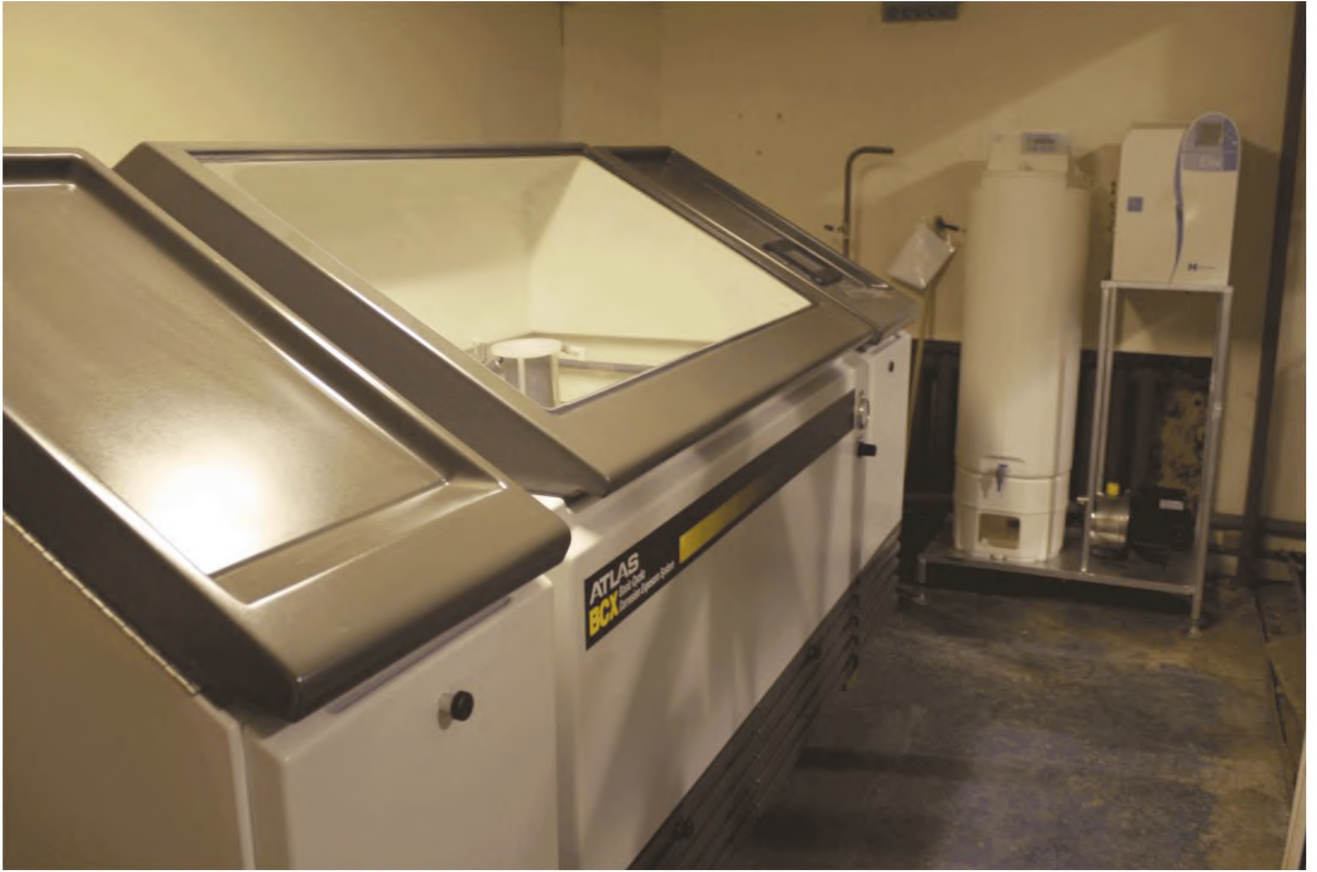
Рисунок Г.13. Камера соляного тумана
