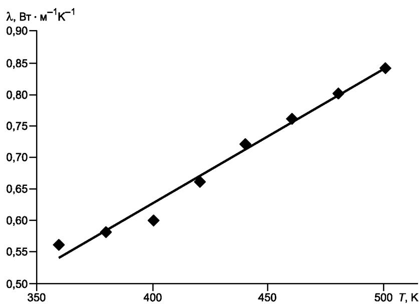
Рисунок А.7 — Температурная зависимость теплопроводности расплава стекла
