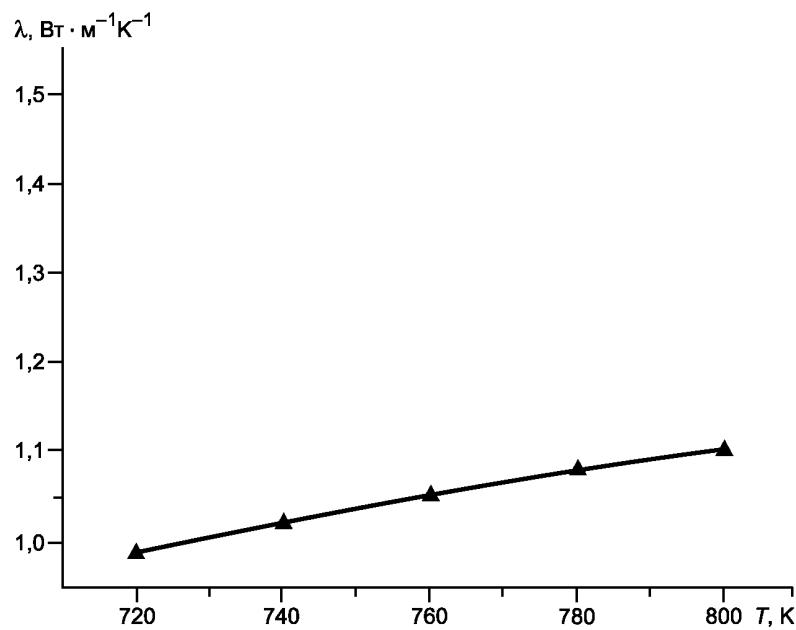
Рисунок А.5 — Температурная зависимость теплопроводности стекла
