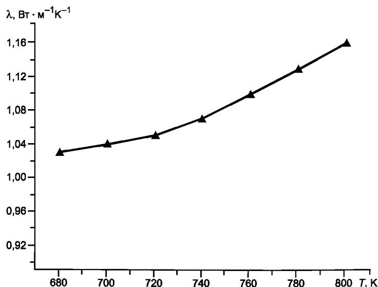
Рисунок А.2 — Температурная зависимость теплопроводности стекла  $\text{TeO}_2 + 12$  мол %  $\text{K}_2\text{O}$  ( $\lambda = 0,002T - 0,231$ )
