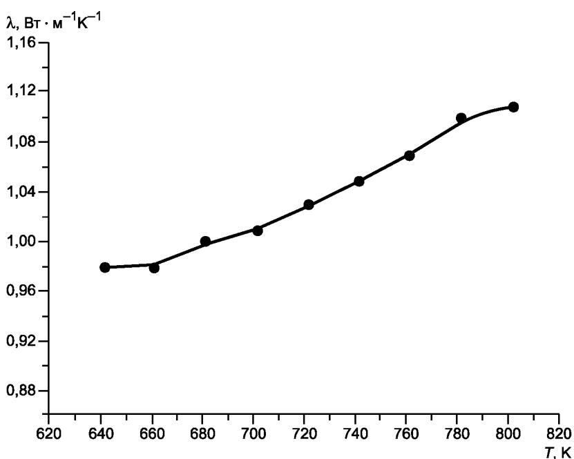
Рисунок А.4 — Температурная зависимость теплопроводности стекла
