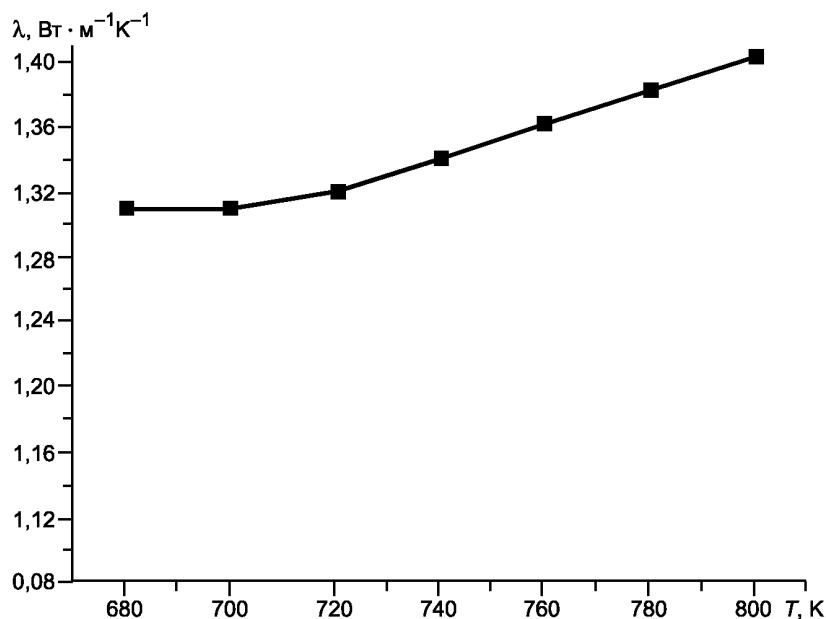
Рисунок А.3 — Температурная зависимость теплопроводности стекла
