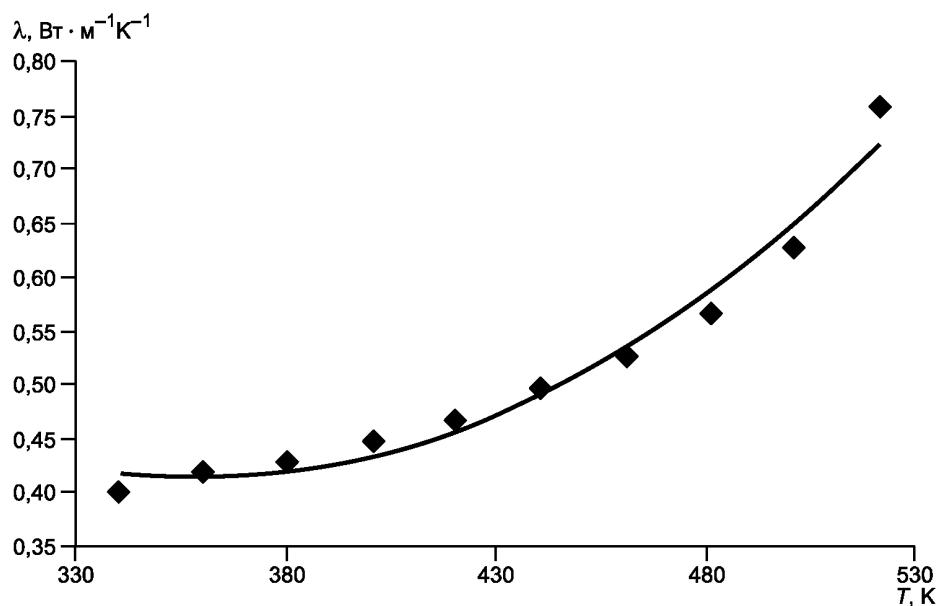
Рисунок А.10 — Температурная зависимость теплопроводности расплава
