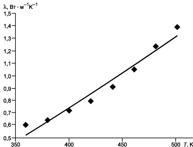
Рисунок А.8 — Температурная зависимость теплопроводности расплава стекла
