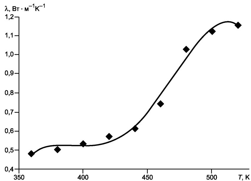
Рисунок А.9 — Температурная зависимость теплопроводности расплава стекла
