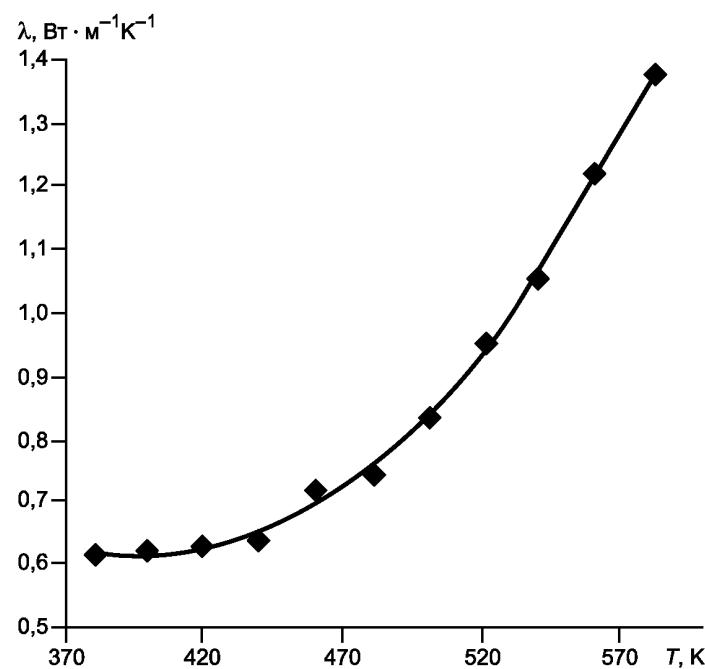
Рисунок А.6 — Температурная зависимость теплопроводности расплава стекла
