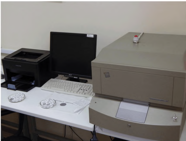
Фото 37 – Лабораторное оборудование. Рентгенофлуоресцентный спектрометр, предназначенный для анализа портландцемента
