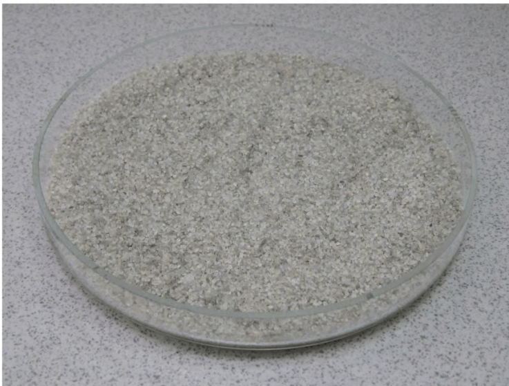
Фото 15 – Пример мелкого заполнителя бетона – кварцевого песка
