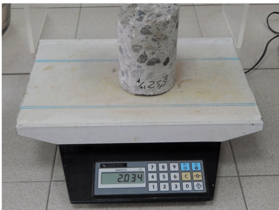
Фото 18 – Определение массы пробы керна
