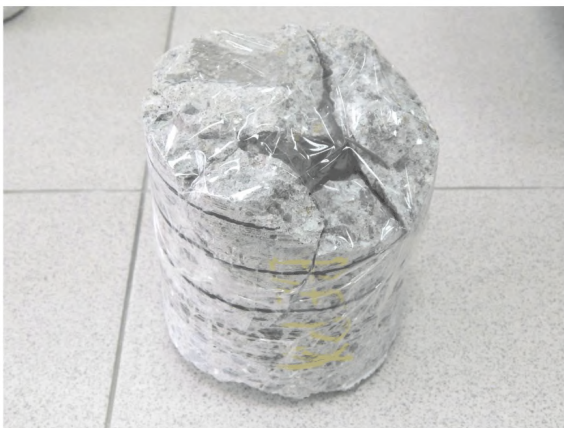
Фото 10 – Проба бетона после отбора растворной части на разной глубине образца
