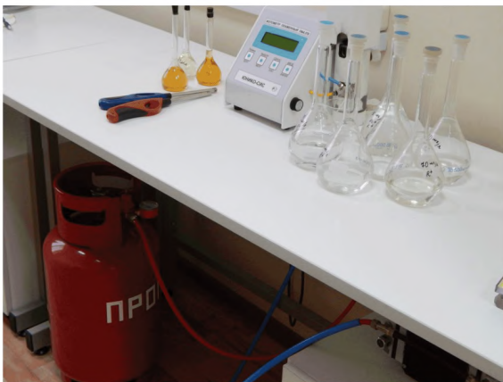
Фото 36 – Лабораторное оборудование. Пламенный фотометр
