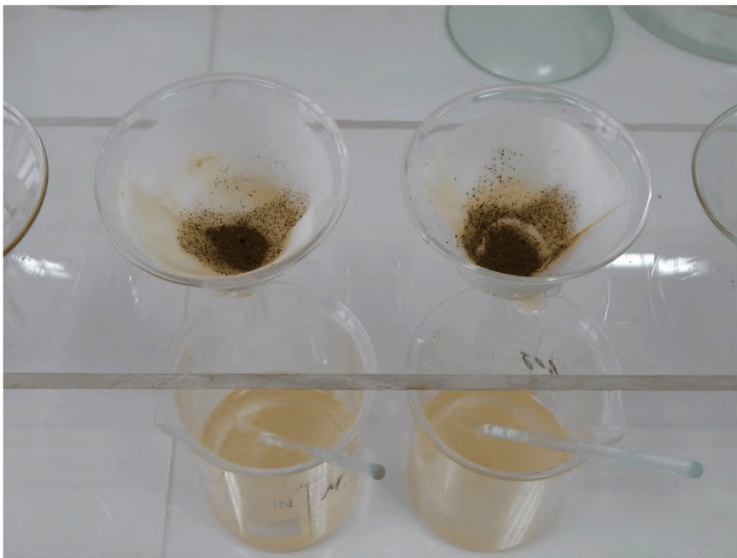
Фото 21 м Обработка растворной части бетона селективными растворителями
