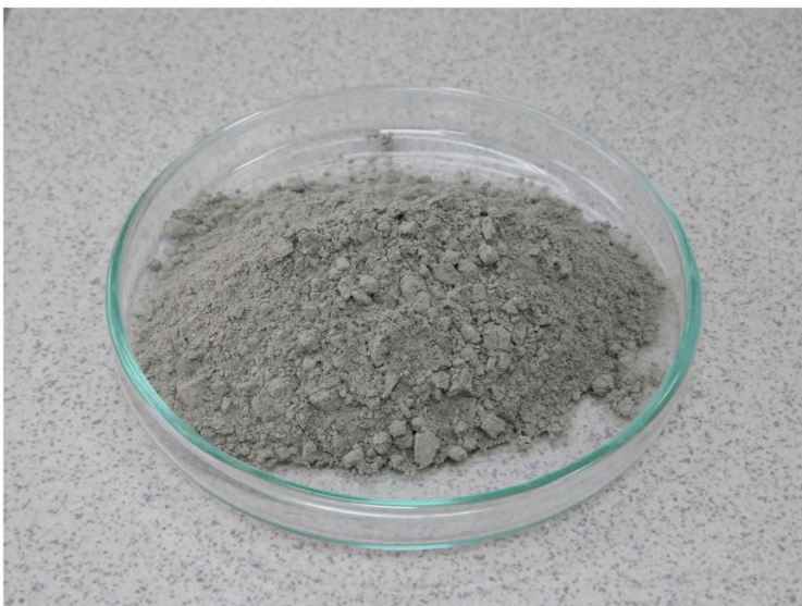
Фото 16 – Пример вяжущего для производства бетона - портландцемент
