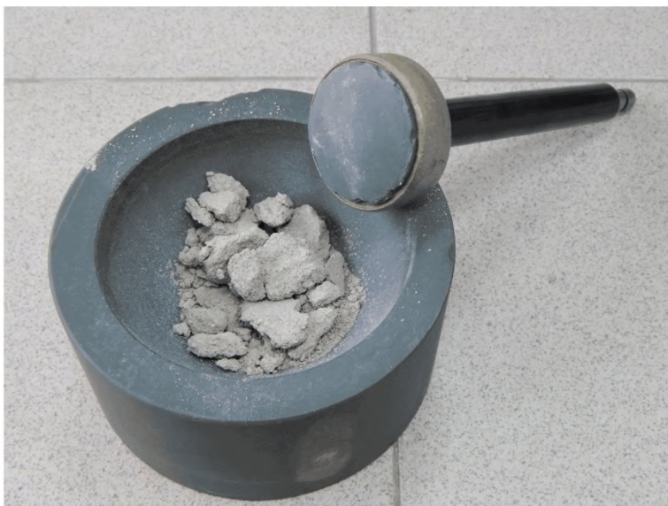
Фото 12 – Измельчение растворной составляющей бетона
