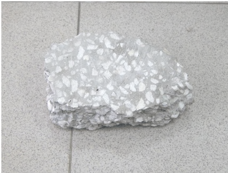
Фото 11 – Пример пробы бетона с карбонатным заполнителем
