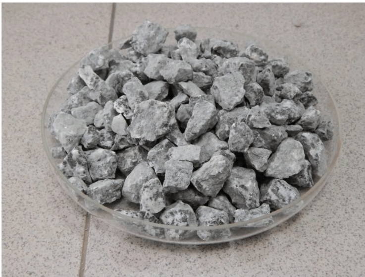
Фото 13 м Пример гравийного щебня – крупного заполнителя бетона
