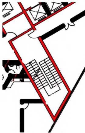
Б) – лестничная клетка Н2
