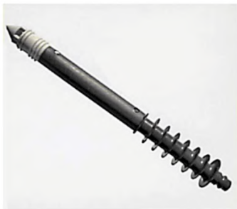
Рисунок 26 – Специальный забивной пластиковый анкер для инъекции цементных растворов в конструкции при незначительном водопроявлении
