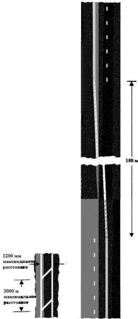
Рисунок Ц.13 – Устройство разметки на участках вогнутых кривых между двумя полосами движения на подъем
