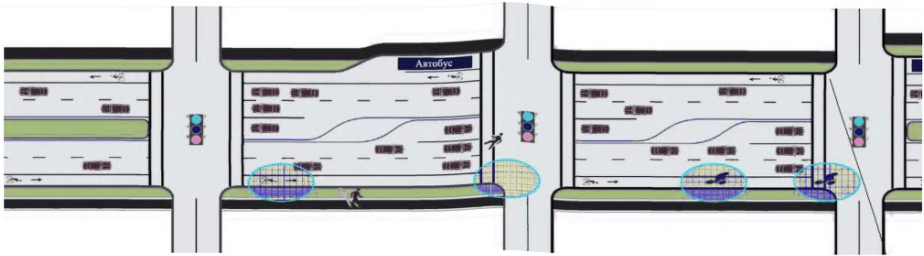
Рисунок Д.3 – Расчетная схема оценки суммарного уровня обслуживания велосипедистов на нескольких сегментах одной улицы
