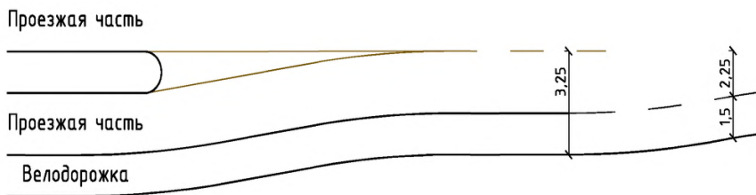
Рисунок Л.3 – Пример окончания велосипедной дорожки
