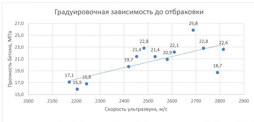
Рисунок 3.4 – График градуировочной зависимости до отбраковки
