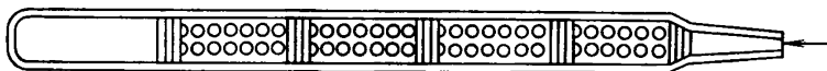
Рис. 1.7. Сорбционная трубка с силикагелем для отбора из воздуха анилина, нитробензола и ароматических углеводородов
