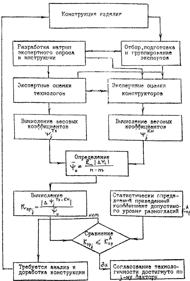
Рис. 2. Алгоритм отработки конструкции изделия на технологичность с использованием принципа минимума разногласий экспертов
