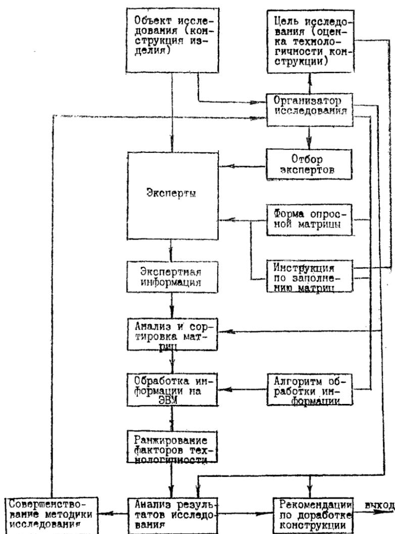
Рис. 1. Схема процесса оценки ТИИ методом экспертных оценок
