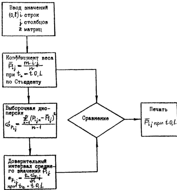
Рис. 5. Алгоритм обработки экспертной информации
