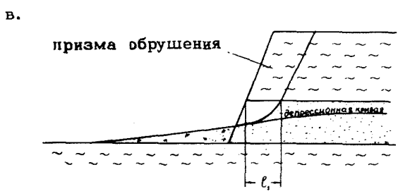
Рис. 9. Схемы оплывающего откоса 1- первоначальное положение откоса, 2- оплывший песок.
