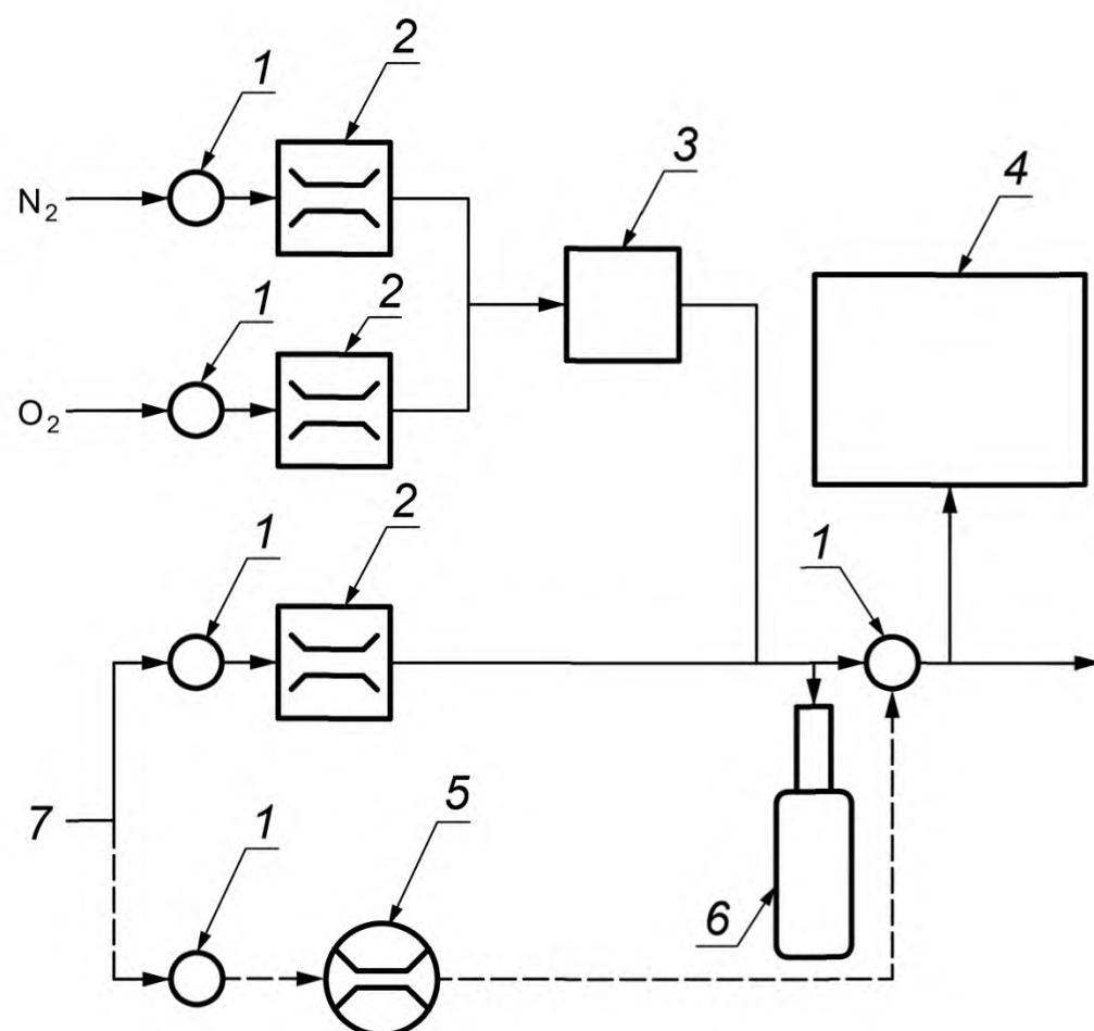
1 — клапан; 2 — регулятор массового потока (РМП); 3 — водяное барботажное устройство; 4 — ГХ-МСД;
