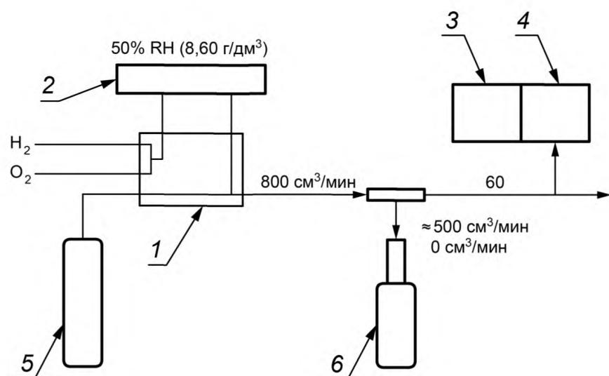
1 — газовая смесь; 2 — увлажнитель, оборудованный терморегулятором, который контролирует давление насыщенного водяного пара, чтобы поддерживать относительную влажность на уровне 20 %, 50 % или 80 % RH при стандартной температуре 20 °C; 3 — ГХ-МСД; 4 — газовый холодильник; 5 — газовый баллон или газогенераторная система; 6 — детектор ЛОС (полупроводниковый детектор, фотоионизационный детектор, детектор ИЭР)
