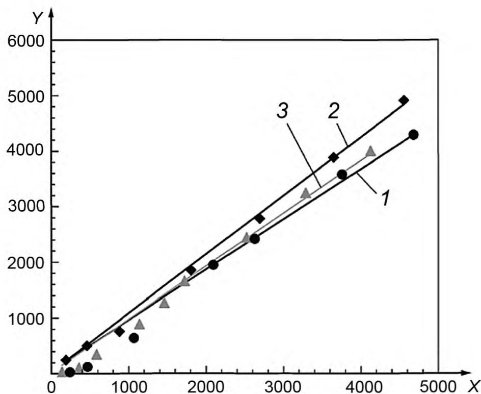
1 — диффузионные трубы «тест 1»; 2 — диффузионные трубы «тест 2»; 3 — газовый баллон
