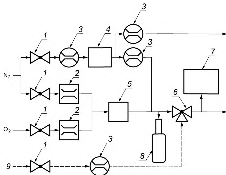
1 — клапан; 2 — регулятор массового потока; 3 — расходомер с игольчатым клапаном; 4 — газогенераторная система;
