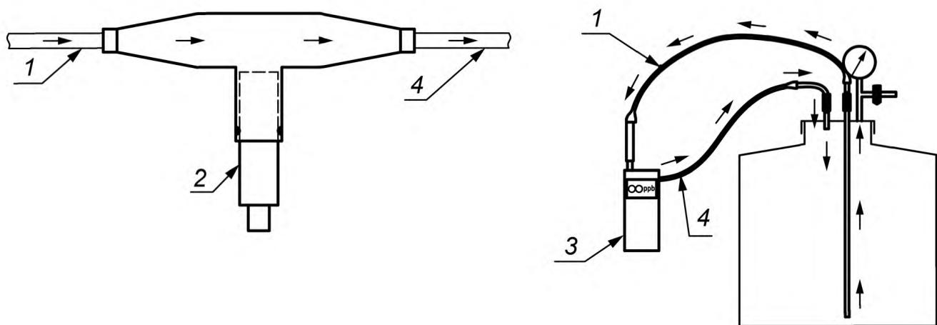
1 — ввод газа; 2 — зонд датчика; 3 — детектор ЛОС; 4 — выход газа
