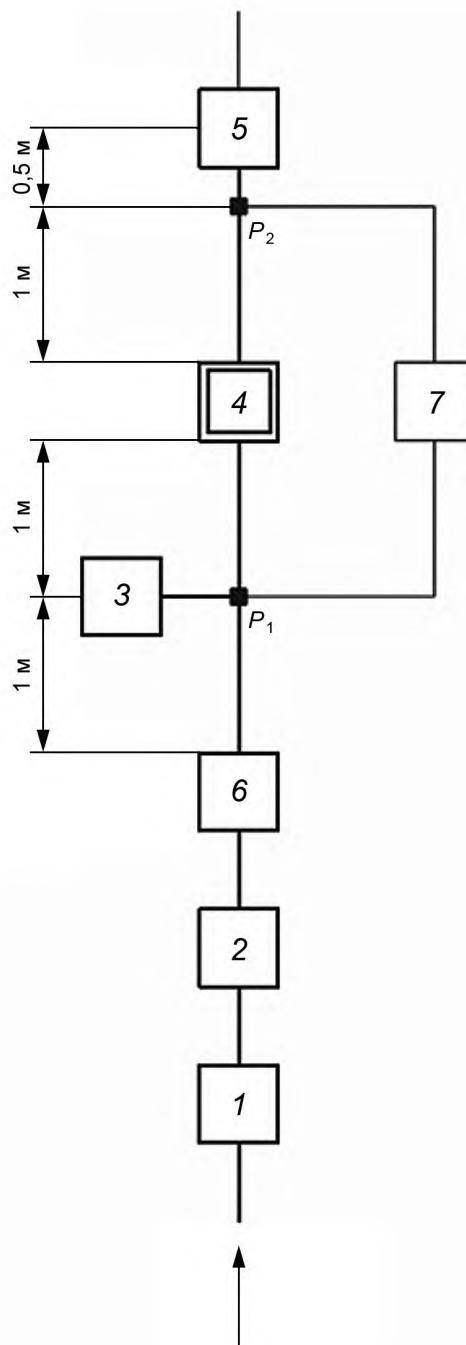
1 — регулятор давления; 2 — расходомер; 3 — манометр; 4 — испытуемый компонент; 5 — выпускной вентиль;
