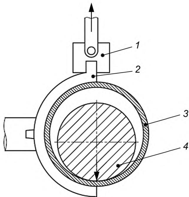
1 — зажимное устройство, способное вращать точку приложения нагрузки; 2 — седловый отвод из ПЭ; 3 — труба из ПЭ; 4 — нагружающий стержень
