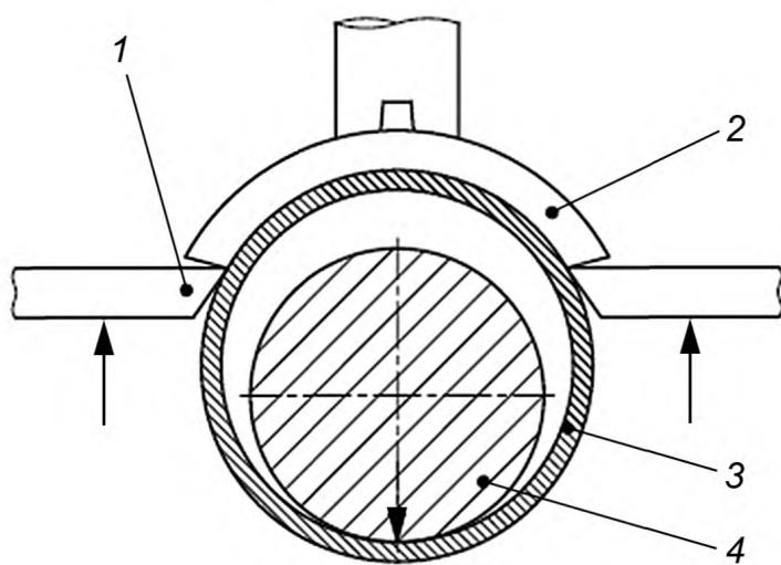
1 — зажимное устройство; 2 — седловый отвод из ПЭ; 3 — труба из ПЭ; 4 — нагружающий стержень
