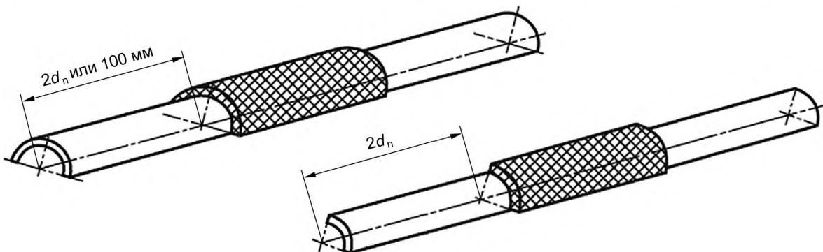
Рисунок ДА.1 — Подготовка испытуемых образцов
