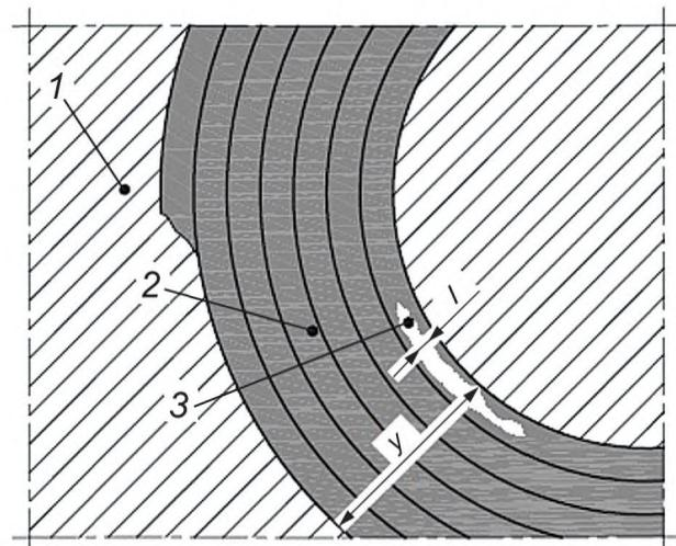
1 — поверхность трубы; 2 — пластическое разрушение; 3 — хрупкое разрушение между витками закладного нагревателя;
