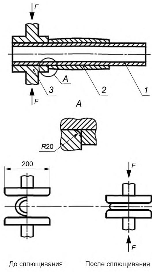
Рисунок ДА.2 — Расположение образцов между плитами испытательной машины
