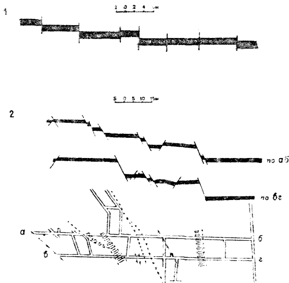
Рис. 50 Сбросы: 1 - ступенчатые. Шахта № 3-4, Донбасс; 2 - ступенчатые и клиновидные. Шахта № 7-7бис, Артёмовское месторождение
