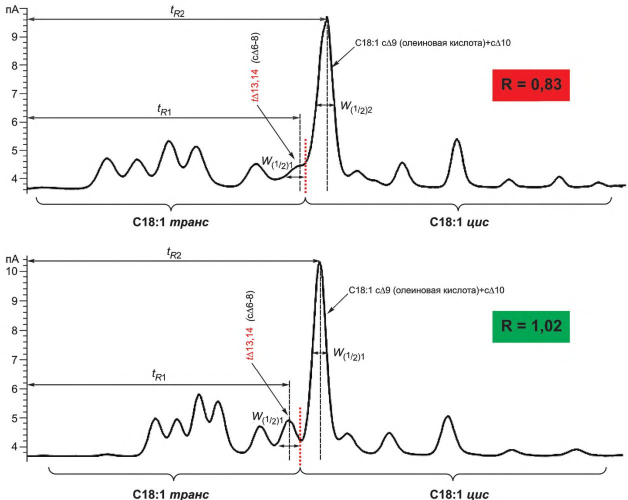
Рисунок В.3 — Пример ГЖХ-хроматограммы (полное и неполное разделение между C18:1 цис- и транс-изомерами)
