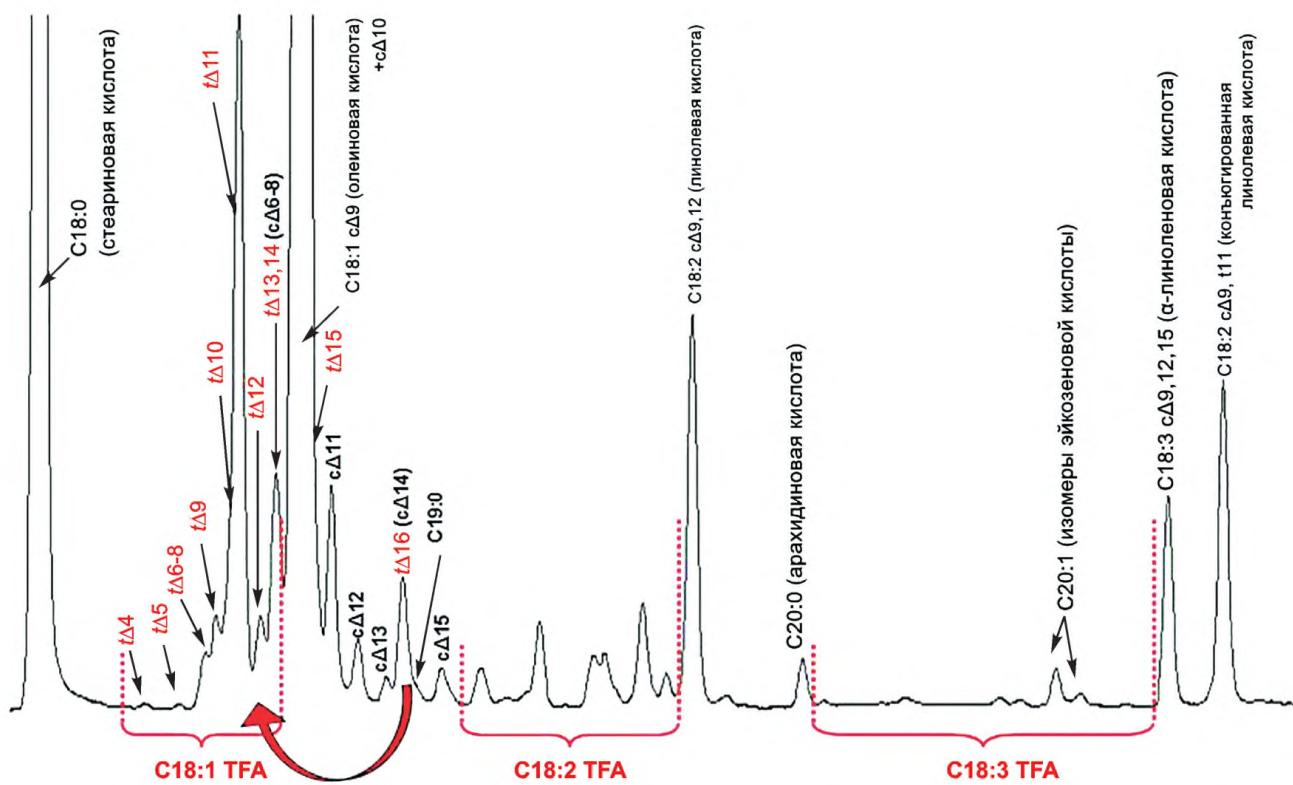
Рисунок В.2 — Пример ГЖХ-хроматограммы молочного продукта [увеличенная область С18:1 ТЖК, С18:2 ТЖК, С18:3 ТЖК и конъюгированная линолевая кислота (CLA)] с использованием ввода пробы непосредственно в колонку
