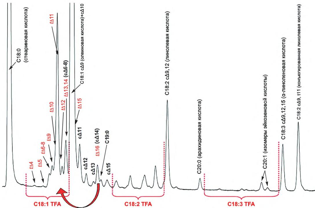
Рисунок В.1 — Пример ГЖХ-хроматограммы молочного продукта [увеличененная область С18:1 ТЖК, С18:2 ТЖК, С18:3 ТЖК и конъюгированная линолевая кислота (CLA)] с использованием ввода пробы с делением потока
