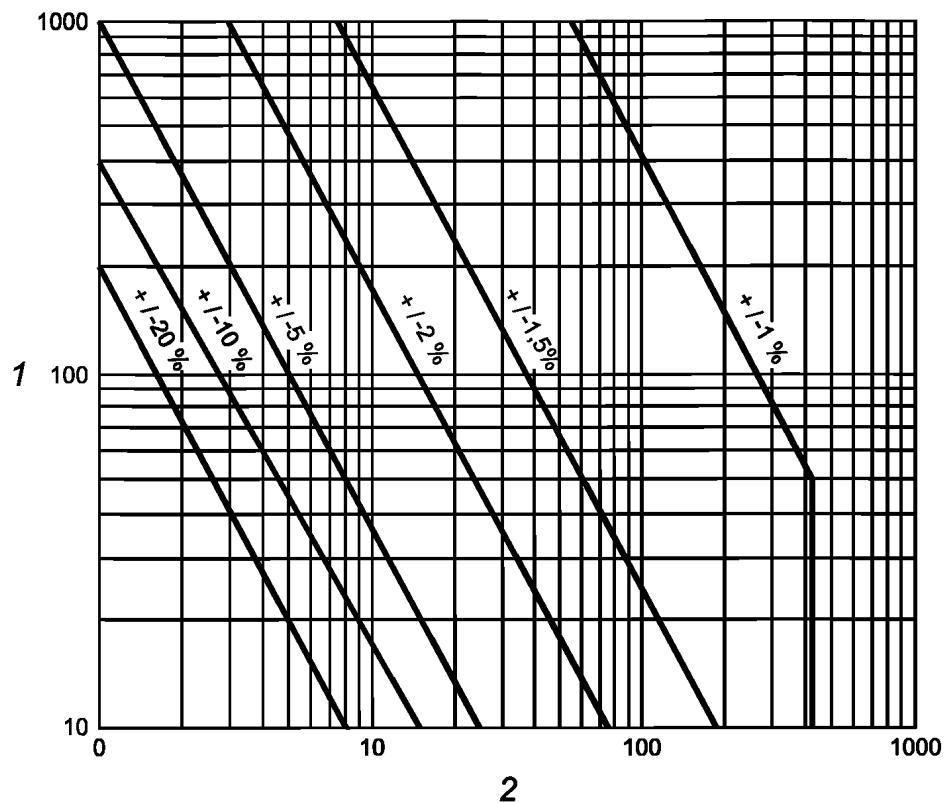
1 — внутренний диаметр трубы, мм; 2 — номинальное давление, бар
