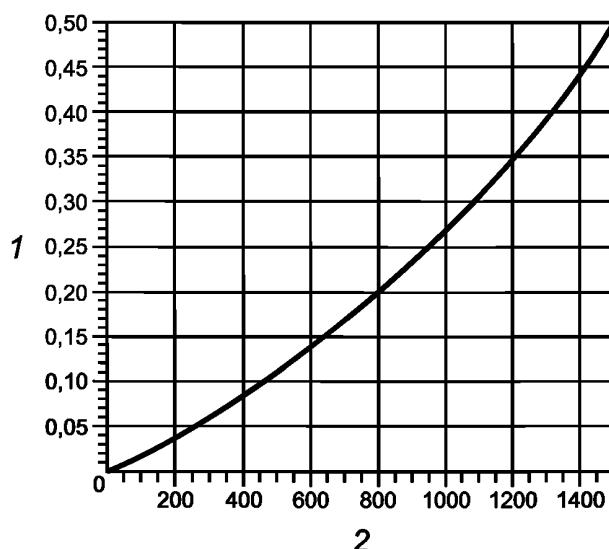
1 — диапазон давлений на входе, М1, бар; 2 — частота вращения вала насоса,  $\text{мин}^{-1}$
