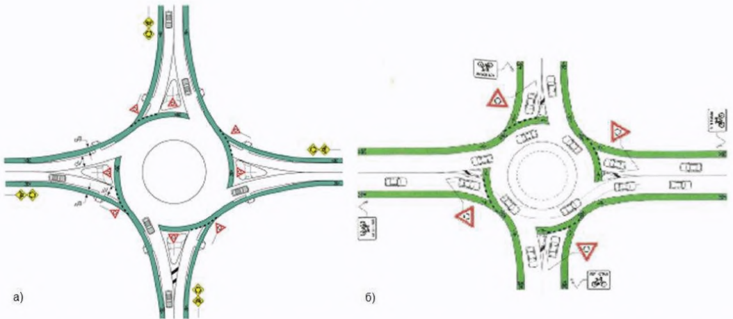
Рисунок 4.4. Пересечение веломаршрутов на однополосном кольцевом пересечении: а) с физическим отделением велополосы на кольцевой проезжей части; б) без физического отделения велополосы на кольцевой проезжей части.
