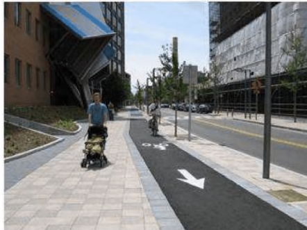
Рисунок 3.10. Пример отделения велодорожки элементами благоустройства
