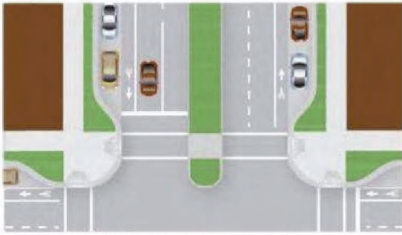
Рисунок 4.7. Примеры выступов бордюров на перекрестке
