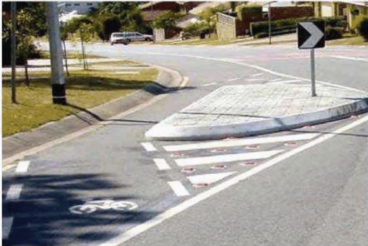
Рисунок 3.7. Пример ограничения выезда автомобильного транспорта на велодорожку
