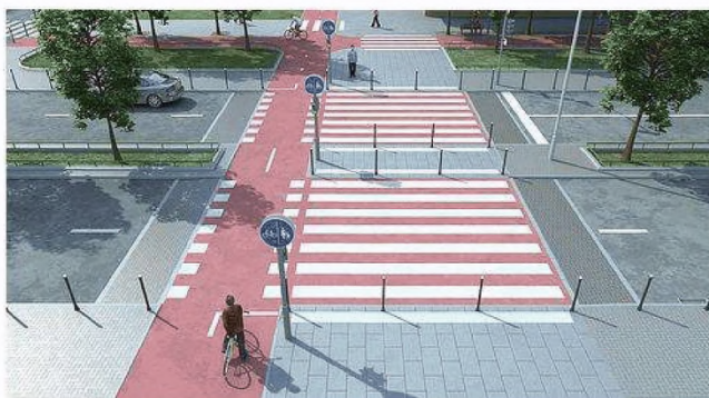
Рисунок 4.10. Пример нерегулируемого вело-пешеходного перехода на искусственной неровности
