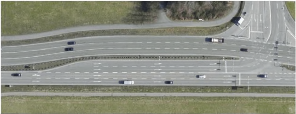
Рисунок 3.15 – Пример устройства сдвоенных выделенных полос для левого поворота – смещение разделительной полосы
