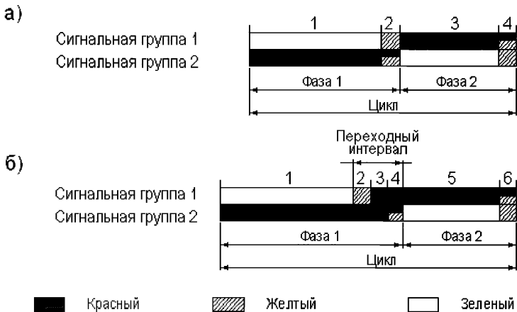
Рисунок 1.3 - Примеры структуры цикла регулирования: а – с одним промежуточным тактом в каждой фазе; б – с тремя промежуточными тактами в составе переходного интервала в первой фазе; 1 – 6 – номера тактов
