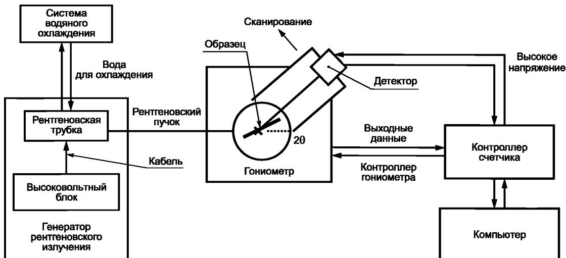
Рисунок 1 — Блок-схема дифрактометрической системы с использованием коротковолнового излучения
