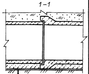
ОСНОВНЫЕ РАЗМЕРЫ И ОБЪЕМ ПОДГОТОВКИ НА 1 м ЖЕЛЕЗОБЕТОННОЙ ТРУБЫ ПРИ УКЛАДКЕ НА ГРУНТАХ С НЕСУЩЕЙ СПОСОБНОСТЬЮ  $0,1 < R_n < 0,15 \text{ МПа}$
