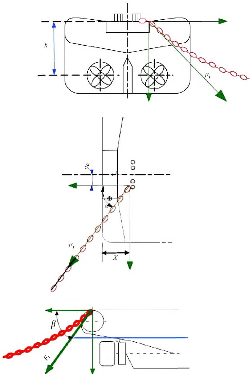
Рис. 1.1.1 Схема расположения углов  $\alpha$  и  $\beta$  и расстояний  $h$ ,  $x$  и  $y$ . Вектором  $F_t$  обозначено направление действия силы натяжения троса
