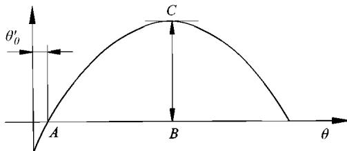
Рис. 1.3 Определение опрокидывающего момента в нерабочем состоянии
