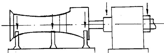
Рис. 9.8.1-2 Точки измерения вибрации
