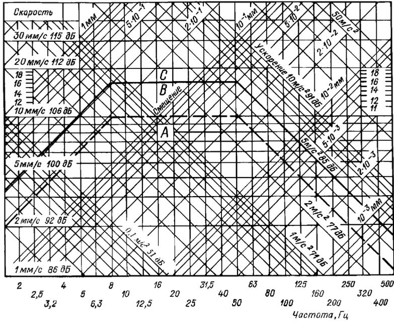
Рис. 9.6.1 Нормы вибрации поршневых компрессоров:
