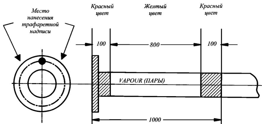
Рис. 6.1.12 Маркировка шланга сдачи паров груза
