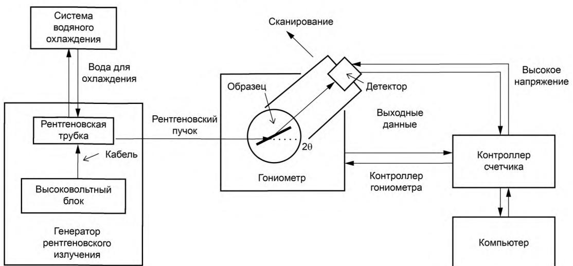
Рисунок 1 — Блок-схема дифрактометрической системы с использованием коротковолнового излучения
