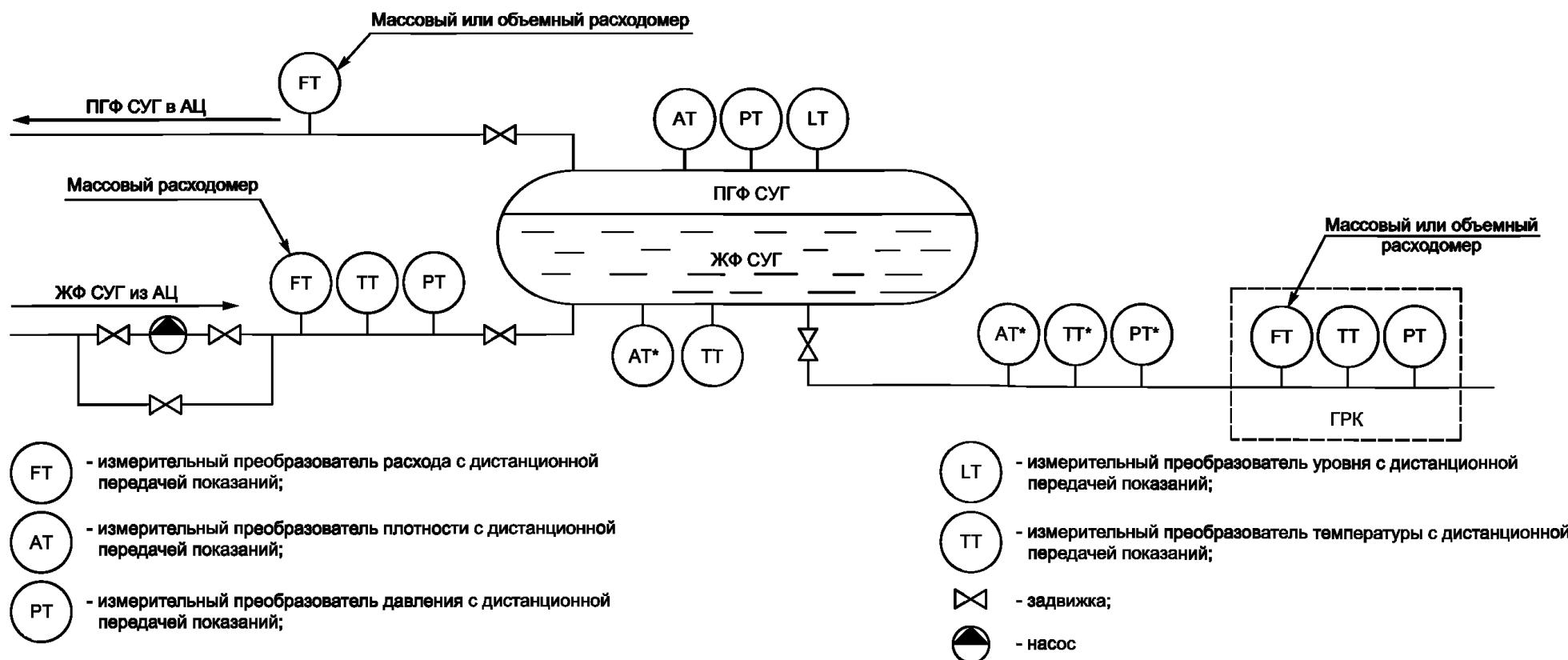
Рисунок Ж.1 — Схема СИК СУГ. Пример №1
