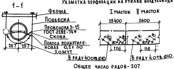
Разметка перфорации на рукаве воздуховода
