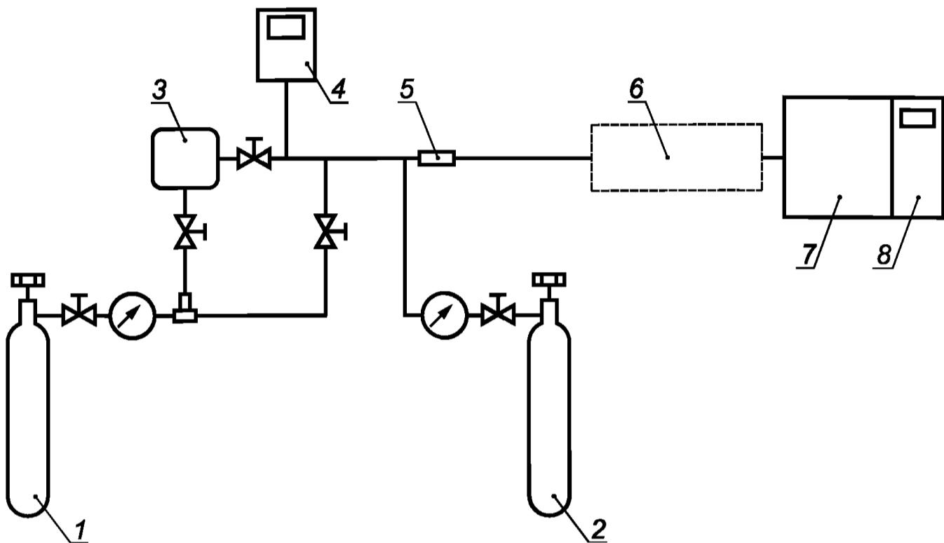
1 — баллон с газом-носителем (азот, воздух); 2 — баллон с газовой смесью ГСО-ПГС; 3 — генератор влажного газа; 4 — анализатор содержания паров воды; 5,6 — система пробоотбора; 7 — блок газоаналитических ИК АИС КВ; 8 — блок технических средств для обработки, хранения, визуализации и передачи данных
