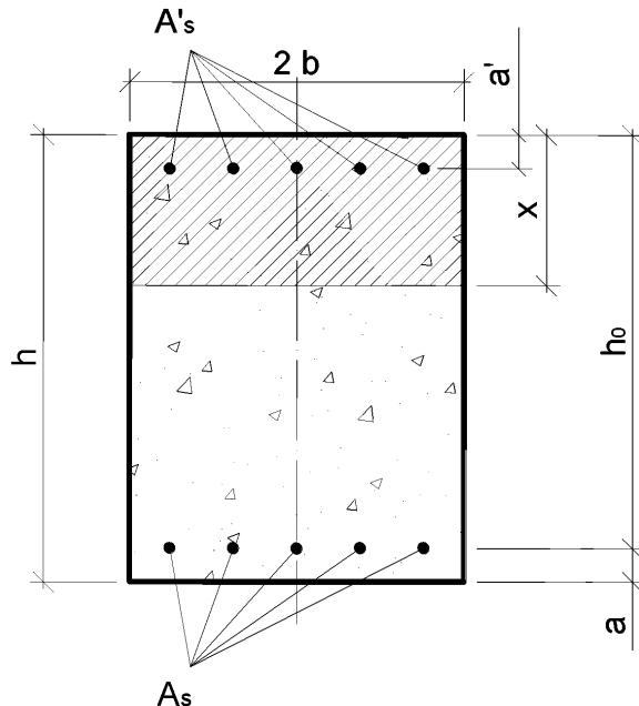
$A_s$  - общая площадь растянутой арматуры;  $A'_s$  - общая площадь сжатой арматуры;  $x$  - высота сжатой зоны;  $h_0$  - рабочая высота сечения
