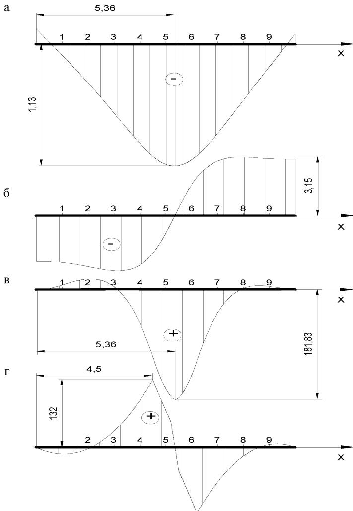
а – эпюра прогибов  $Y$ , мм; б – эпюра углов поворота  $\varphi \cdot 10^{-4}$ , рад; в – эпюра изгибающих моментов  $M$ , кН м; г – эпюра поперечных сил  $Q$ , кН
