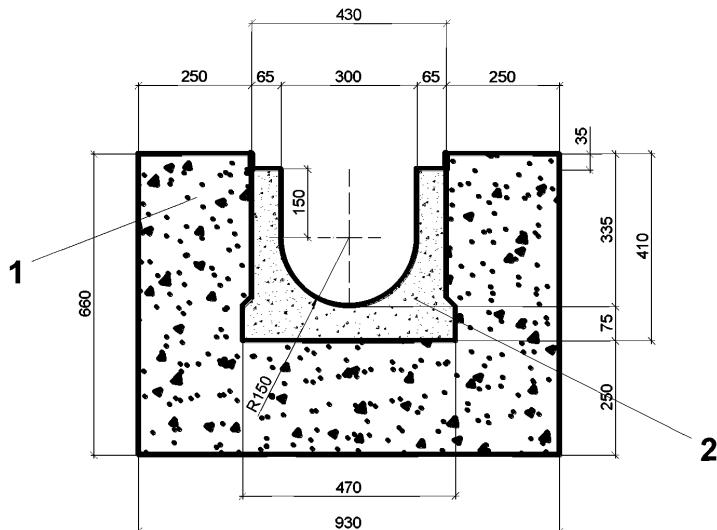
1 – закрытый лоток; 2 – обойма омоноличивания лотка
