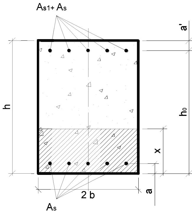
$A_s$  - общая площадь сжатой арматуры, определяемой на первом этапе как растянутой;  $A_{s1}$  - общая площадь растянутой арматуры;  $X$  - высота сжатой зоны;  $h_0$  - рабочая высота сечения
