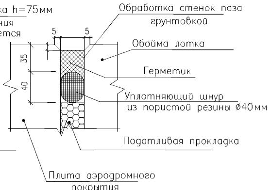
Рисунок 5 - Герметизация швов конструкции закрытого лотка
