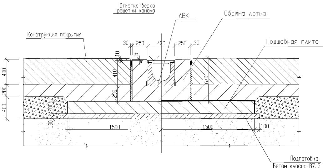
Рисунок 6 - Конструкция закрытого лотка на перроне аэродрома
