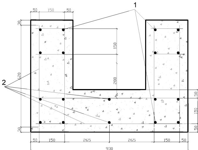
1 – стержни продольной расчетной арматуры А-300,  $d=14$  мм, 2 – стержни конструктивной арматуры
