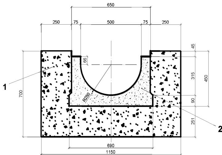
1 – закрытый лоток; 2 – обойма омоноличивания лотка
