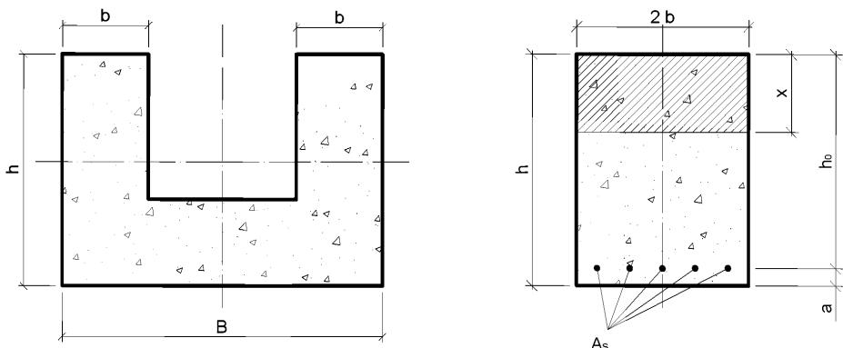
$A_s$  - общая площадь растянутой арматуры;  $x$  - высота сжатой зоны;  $h_0$  - рабочая высота сечения
