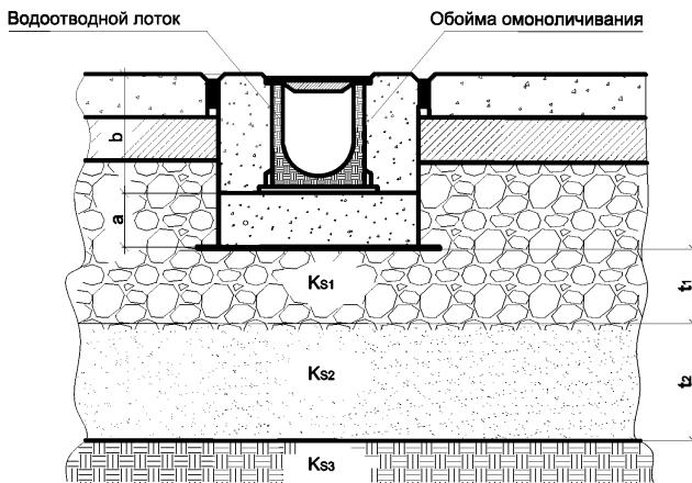
Рисунок 13 - Схема определения эквивалентного коэффициента постели  $K_{se}$
