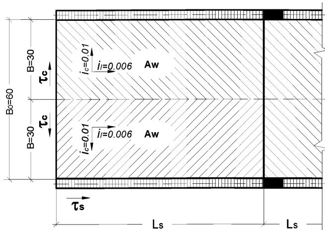
Рисунок Д.1 – Расчетная схема к гидравлическому расчету
