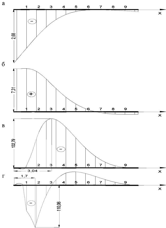
а – эпюра прогибов  $Y$ , мм; б- эпюра углов поворота  $\phi \cdot 10^{-4}$ , рад; в – эпюра изгибающих моментов  $M$ , КН м; г – эпюра поперечных сил  $Q$ , КН
