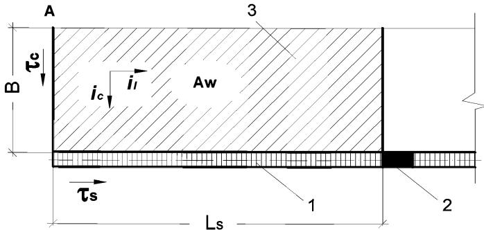
A – наиболее удаленная точка водосбора; 1- закрытый лоток; 2- дождеприемный колодец; 3 – водосборная площадь
