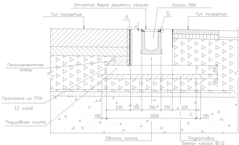
Рисунок 7 - Конструкция закрытого лотка на ВПП аэродрома
