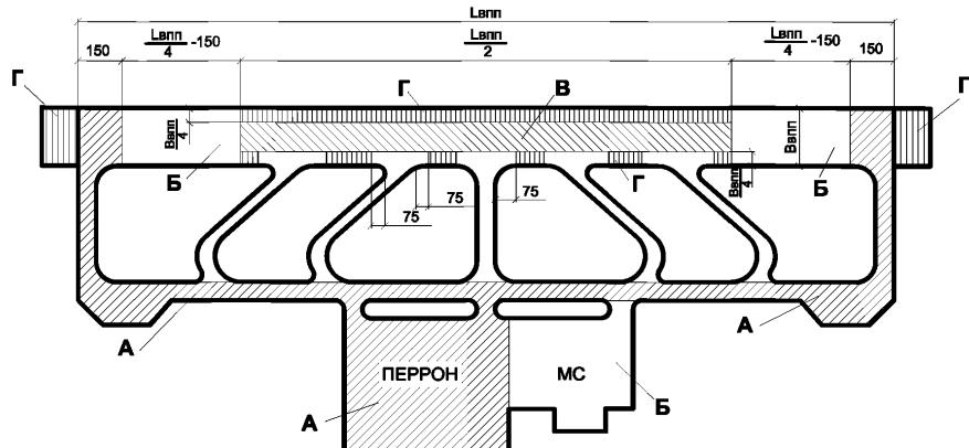
Рисунок 12 - Схема деления покрытий аэродрома на группы участков
