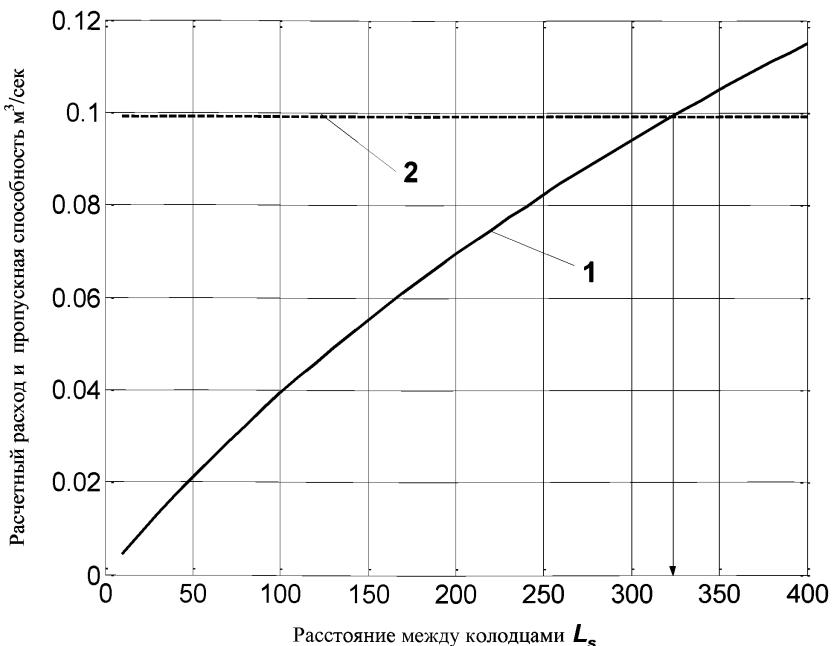
1 – расчетный расход с водосборной площади; 2 – пропускная способность лотка
