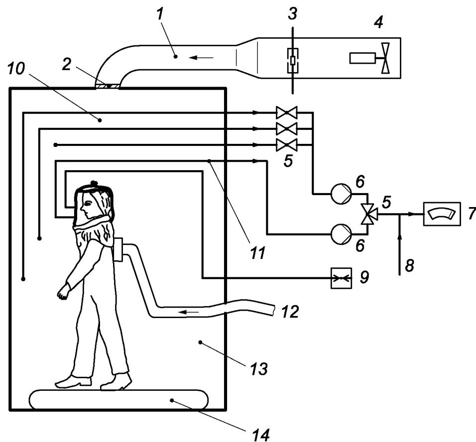
1 — труба; 2 — заслонка; 3 — распределитель воздушного потока; 4 — вентилятор; 5 — переключающий клапан; 6 — насос; 7 — анализатор SF<sub>6</sub>; 8 — дополнительная подача воздуха; 9 — манометр; 10 — пробоотборник в камере; 11 — пробоотборник в дыхательной зоне; 12 — воздух для дыхания; 13 — камера; 14 — беговая дорожка
