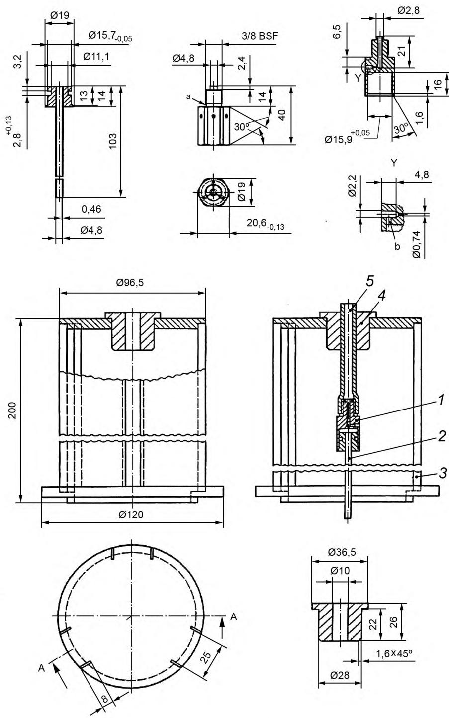
1 — сопло; 2 — подающая труба (раствор соли); 3 — рукоятка; 4 — втулка; 5 — трубка для воздуха (наружный диаметр 10,0 мм)
