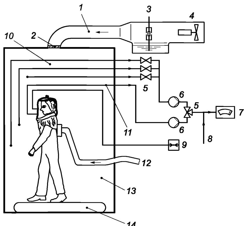
1 — труба; 2 — заслонка; 3 — распределитель воздушного потока; 4 — вентилятор; 5 — переключающий клапан; 6 — насос; 7 — фотометр; 8 — дополнительная подача воздуха; 9 — манометр; 10 — пробоотборник в камере; 11 — пробоотборник в дыхательной зоне; 12 — воздух для дыхания; 13 — камера; 14 — беговая дорожка
