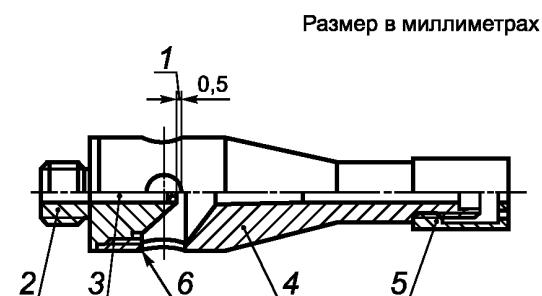
а) Устройство газовой горелки
