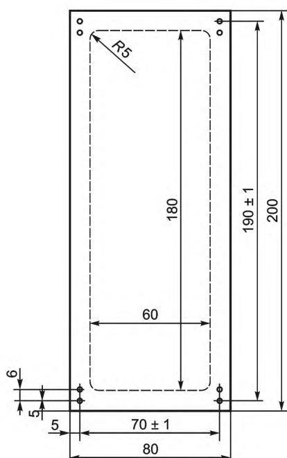
б) Держатель испытуемого образца для процедуры В
